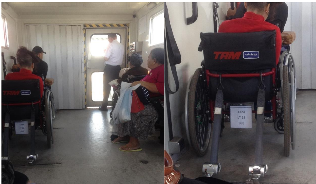
Figura 4.20 Acompanhamento de PNAEs no ambulift pelo despachante. Observa-se (à direita) a cadeira de rodas fixada ao chão por dois cintos de segurança, para evitar seu deslocamento na movimentação do equipamento.
