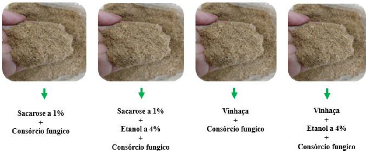
Figura 3. Bagaço de cana-de-açúcar como suporte sólido impregnado com diferentes soluções impregnantes e aplicação do consórcio microbiano de Aspergillus niger e Trichoderma reesei .
