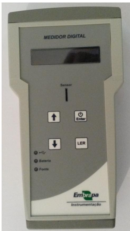
Figura 18 – Foto do instrumento finalizado, mostrando as interfaces com o usuário (display, teclas e sinalizadores da bateria, fonte e USB), e o compartimento para inserção do sensor PET/PANI.
