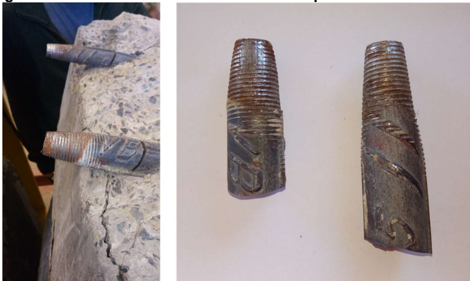
Figura 4.12: Formato das roscas das barras após o término do ensaio
