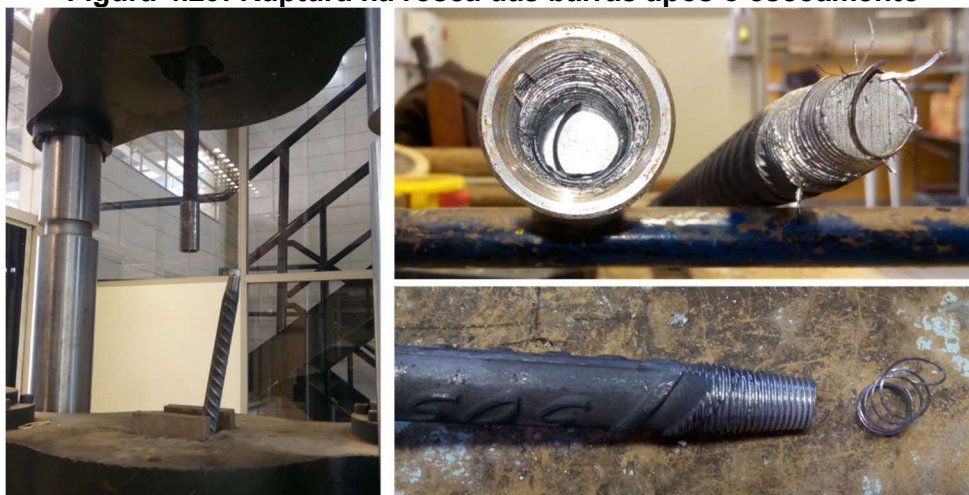
Figura 4.29: Ruptura na rosca das barras após o escoamento
