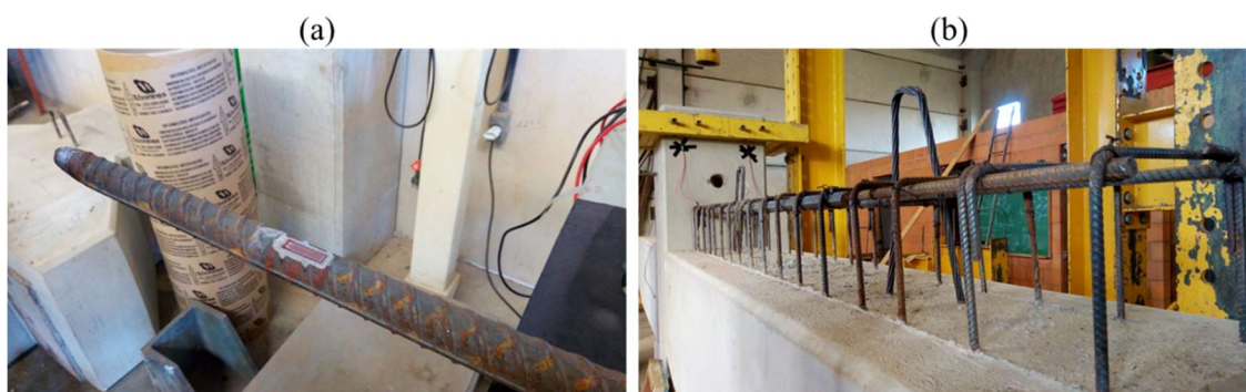
Figura C.5: (a) Strain gauge colado à armadura negativa, com rosca já confeccionada (b) Armadura negativas rosqueadas às luvas do pilar
