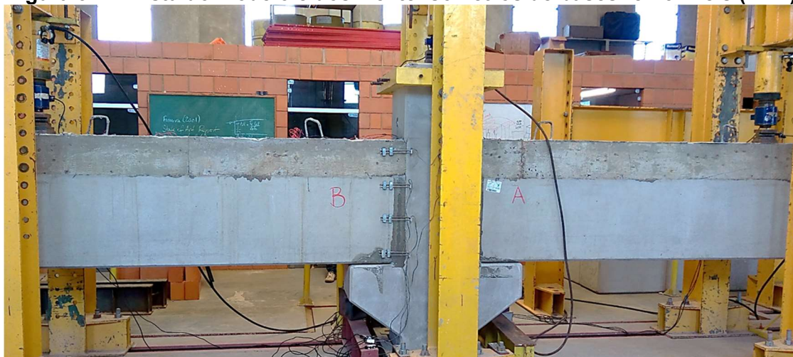
Figura 3.27: Vista do modelo e dos 4 extensômetros de bases removíveis (EBR)
