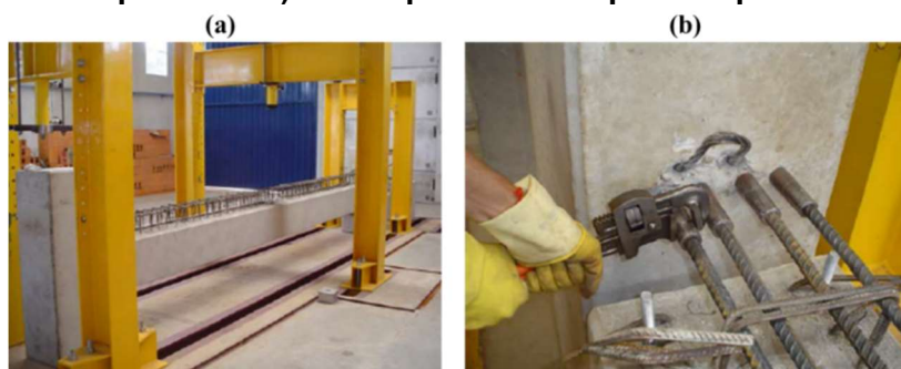
Figura 2.42: (a) Esquema do ensaio à flexão (b) Rosqueamento das luvas (já prensadas) no adaptador em espera no pilar
