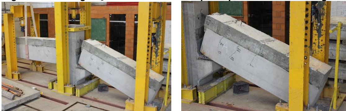
Figura 4.20: Configuração final do modelo 2 após ruptura da armadura negativa
