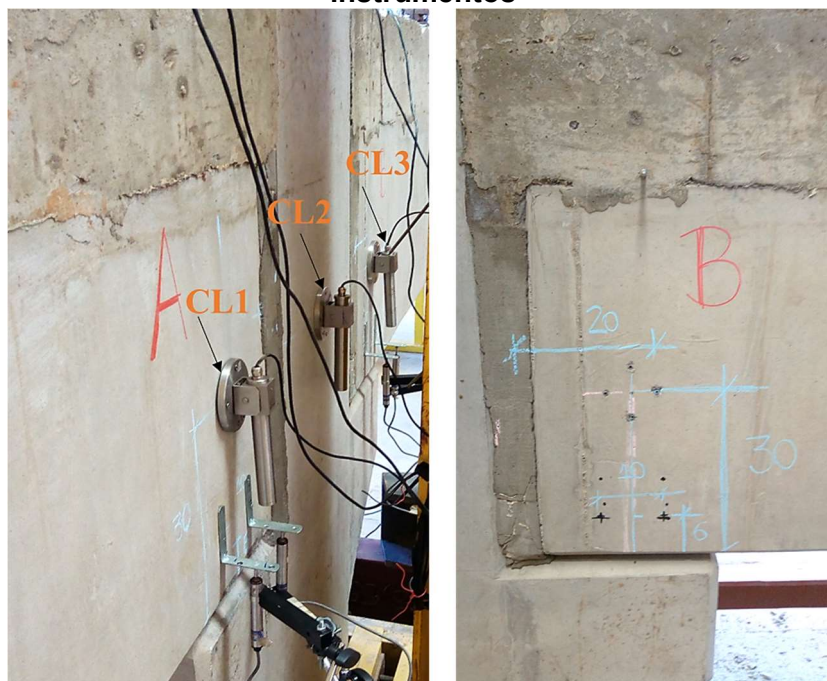
Figura 3.29: Clinômetros e marcação dos furos feita previamente para fixar os instrumentos
