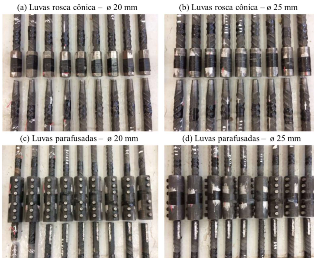
Figura 2.29: Conjunto das amostras de barras e luvas após os ensaios
