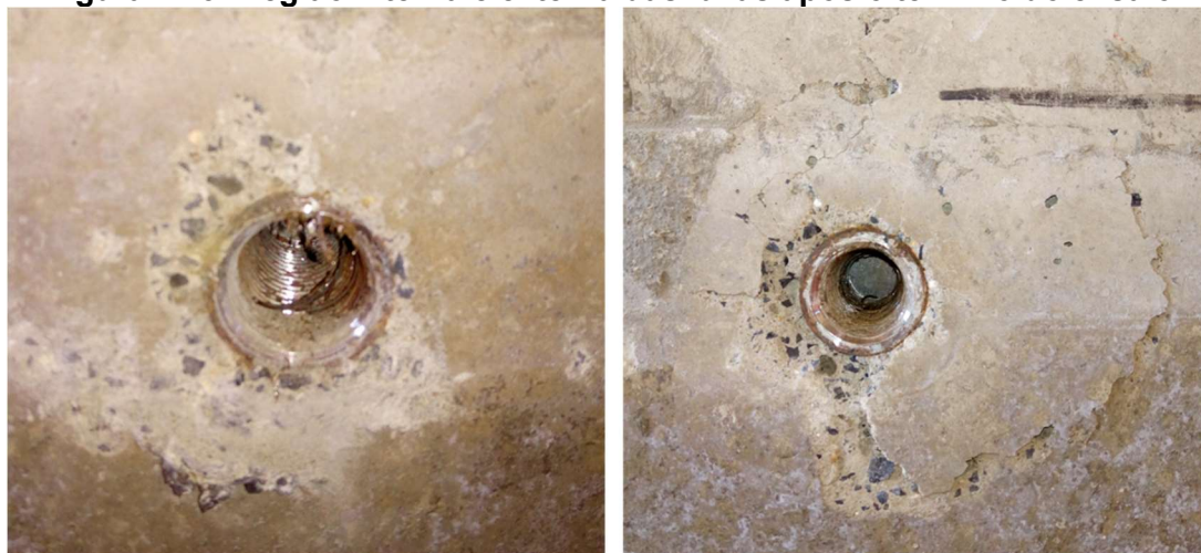
Figura 4.13: Região interna e externa das luvas após o término do ensaio
