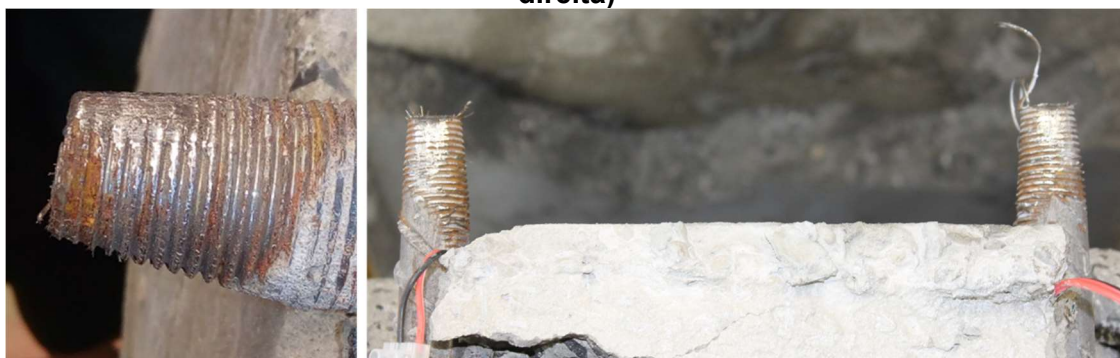
Figura 5.1: Configuração das roscas após os ensaios 1 (à esquerda) e 2 (à direita)
