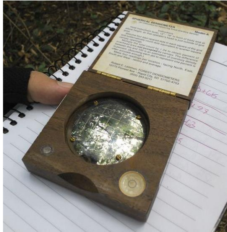
Figura 6- Densiômetro convexo utilizado neste estudo. Fonte: Autoria própria
