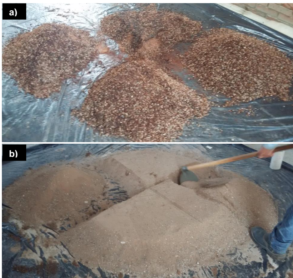
Figura 5.3 – Quarteamento dos agregados graúdo (a) e miúdo (b)
