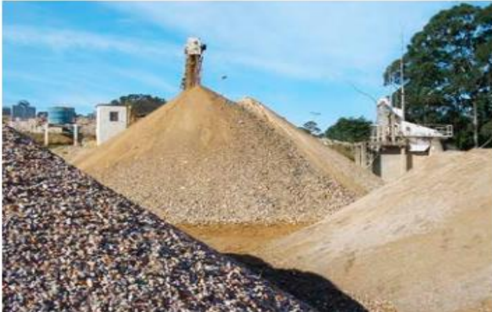
Figura 2.5 - Reciclagem de resíduos da classe A para a produção de agregados
