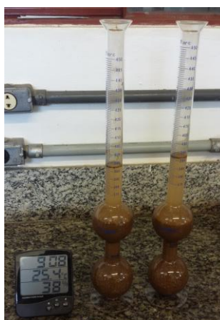
Figura A. 4 - Determinação da massa específica pelo método do frasco de Chapman
