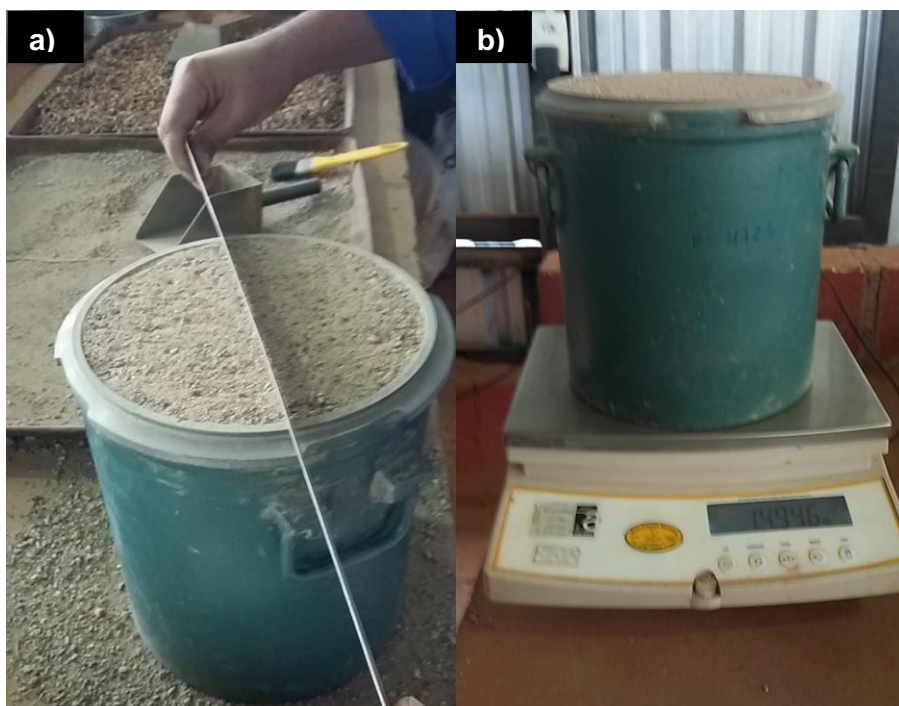
Figura A. 2 - Determinação da massa unitária: nivelamento da camada superficial do agregado (a), determinação da massa do recipiente e seu conteúdo (b)
