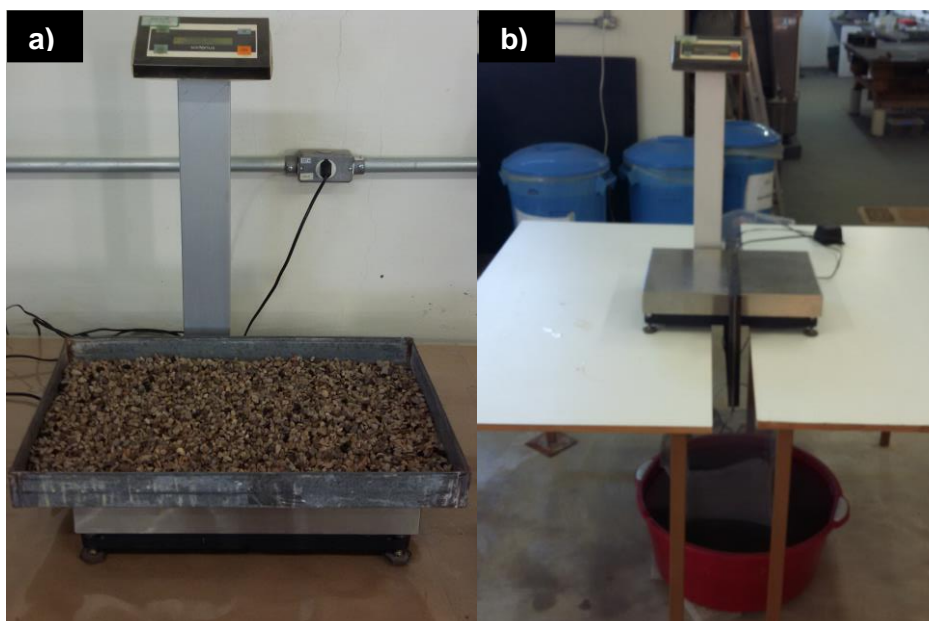
Figura A. 7 - Determinação da massa específica: pesagem do agregado na condição saturado superfície seca (a), determinação da massa submersa (b)
