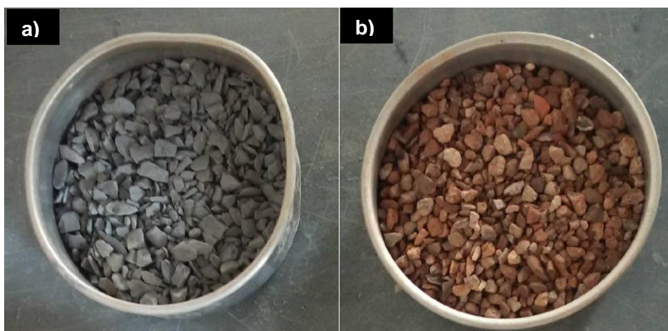
Figura 5.5 - Agregado graúdo natural D_{máx} 9,5 mm (a) e agregado graúdo reciclado D_{máx} 9,5 mm (b)
