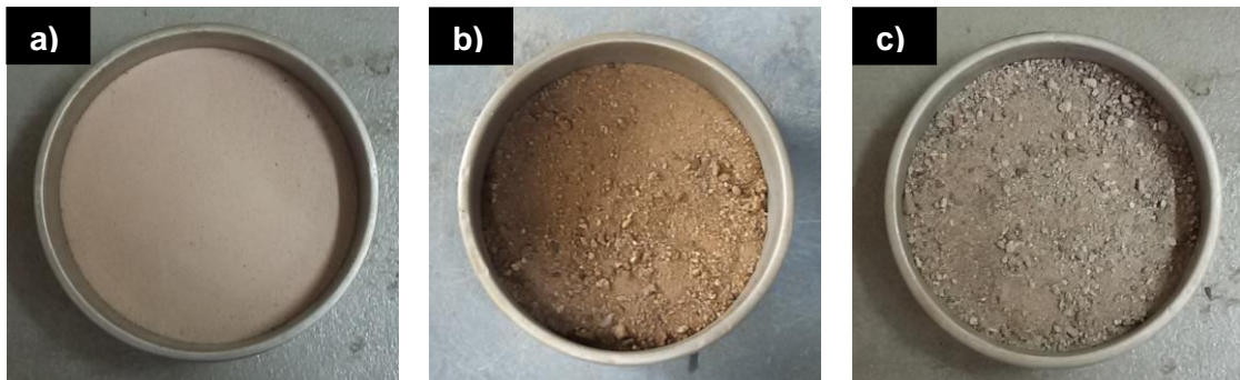
Figura 5.4 - Agregado miúdos: agregado miúdo natural MF 1,07 (a), agregado miúdo natural MF 2,47 (b) e agregado miúdo reciclado MF 2,86 (c)
