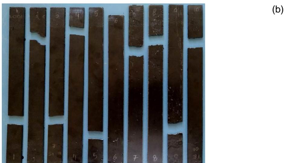
Corpos de prova (a) antes e (b) após ensaio de tração dos compósitos extrusados de HIPS reciclado com argila Claytone 40.
