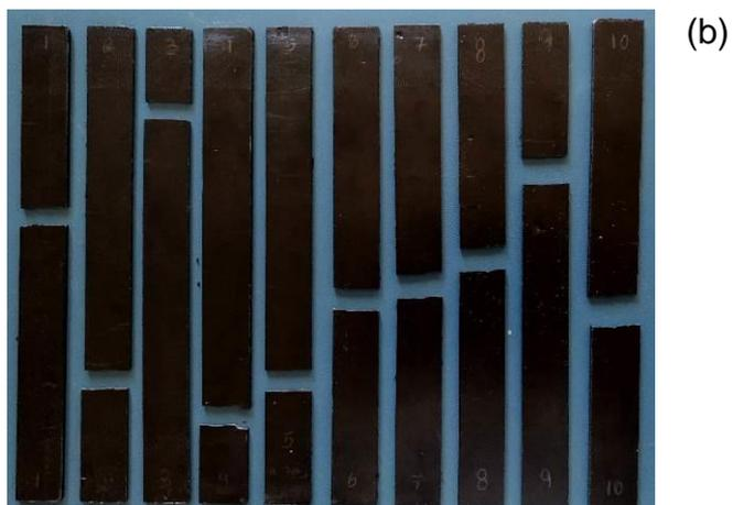
Corpos de prova (a) antes e (b) após ensaio de tração dos compósitos extrusados de HIPS reciclado com argila Coisite 15A.
