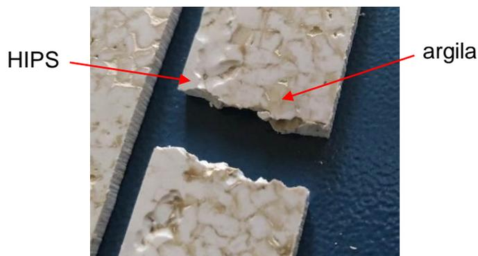
A redução da resistência à tração máxima e da deformação até a ruptura para compósitos com argilas organofilizadas é intensificada em comparação ao HIPS reciclado sem argila, porém, isso não ocorre quando o compósito é preparado ao adicionar a argila no processo de extrusão, o qual proporciona maior dispersão e interação com o polímero. É possível que ocorra mudança da morfologia devido a interação polímero/argila e afeta a elasticidade da fase
