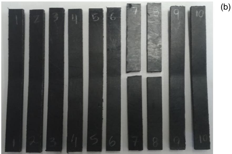
Corpos de prova (a) antes e (b) após ensaio de flexão dos compósitos extrusados de HIPS reciclado lote com argila Cloisite 15A.
