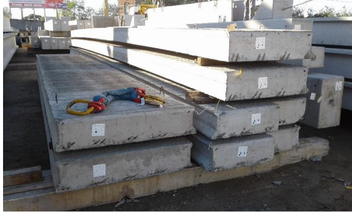
Figura 5-2: Vista da extremidade da laje alveolar moldada por fôrma e interrupção do EPS
