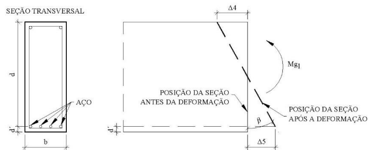
Figura 3-4: Deformação da seção após peso próprio
