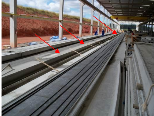
Figura 5-13: Laje alveolar com o comprimento da pista
