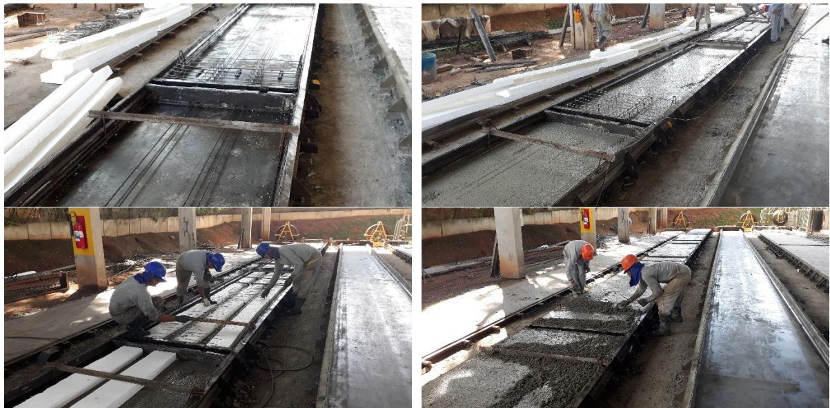
Figura 1-1: Etapas de produção de laje alveolar moldada por fôrma fixa, e com utilização de EPS
