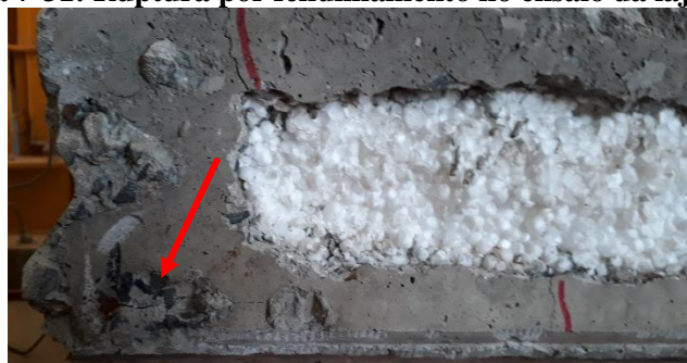
Figura 7-31: Ruptura por fendilhamento no ensaio da laje L04A
