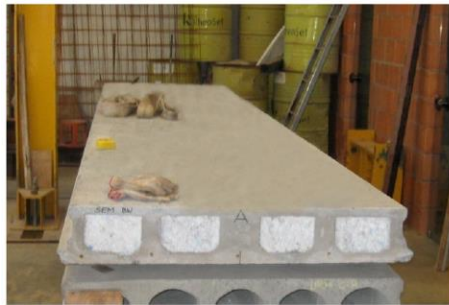
Figura 5-4: Utilização de EPS para a forma do alvéolo
