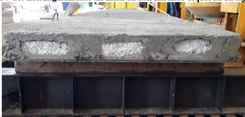
Figura 7-18: Estrangulamento da alma da extremidade esquerda da laje L04A
