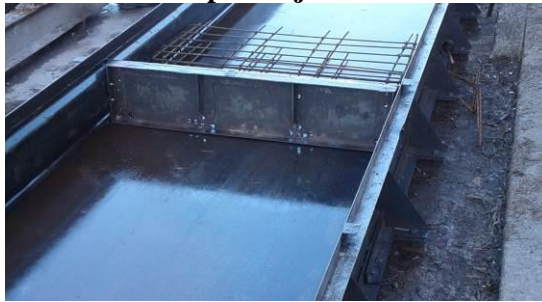
Figura 5-9: Laterais metálicas para laje alveolar moldada por fôrma fixa
