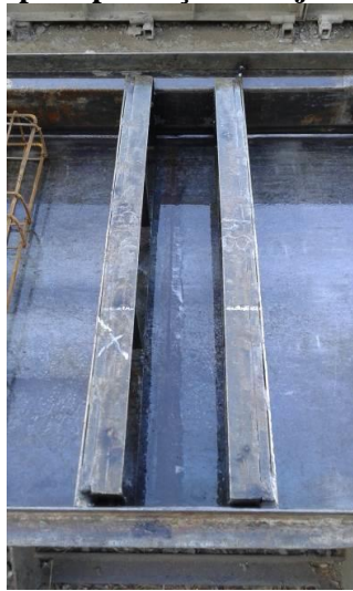
Figura 5-11: Tampas extremas para produção de laje alveolar moldada por fôrma fixa
