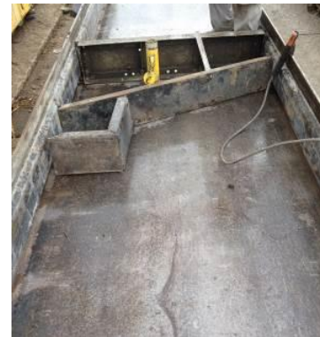
Figura 5-44: Configuração da fôrma para produção da laje alveolar moldada por fôrma fixa com recorte
