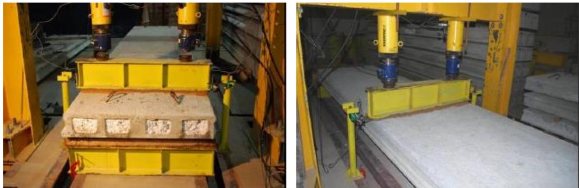
Figura 2-21: a) Determinação da resistência à força cortante; b) Determinação da resistência à flexão
