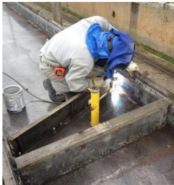
Figura 5-44: Configuração da fôrma para produção da laje alveolar moldada por fôrma fixa com recorte
