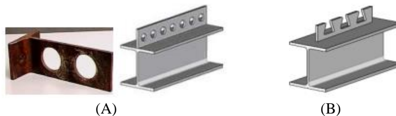
Figura 3.8: Conectores de cisalhamento existentes, sendo: (A) perfil perfobond; (B) conector tipo CRbond
