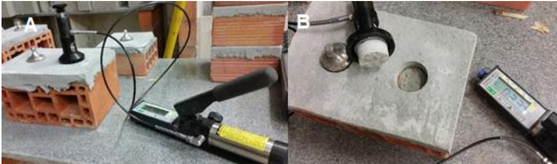
Figura 45- A) Realização de ensaio de arracamento B) Amostra extraída pelo ensaio
