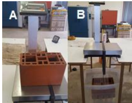
Figura 28- A) Pesagem na balança de precisão 1g B) Pesagem em balança hidrostática
