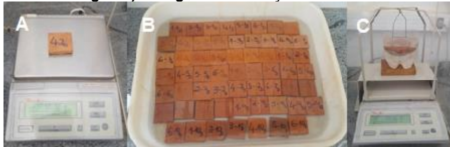
Figura 37- A) Pesagem da massa seca das amostras B) Imersão das amostras em água C) Pesagem em balança hidrostática
