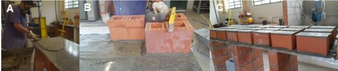
Figura 41- Preparação da massa cimentícia B) Nivelamento do bloco C) Blocos capeados
