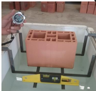
Figura 29- Imersão dos blocos em fio de água por 60 segundos
