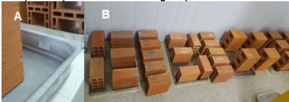
Figura 32- A) Colocação das amostras em água B) Posicionamento das amostras
