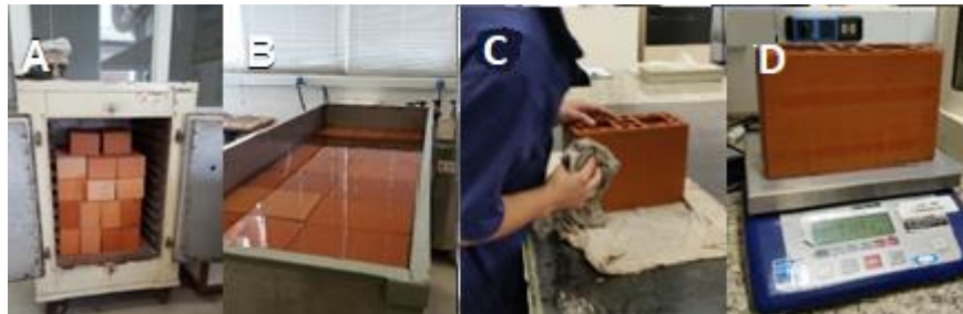
Figura 25- A) Colocação dos blocos em estufa B) Colocação dos blocos em água fria C) Remoção de excesso de água com pano úmido D) Pesagem das amostras úmidas
