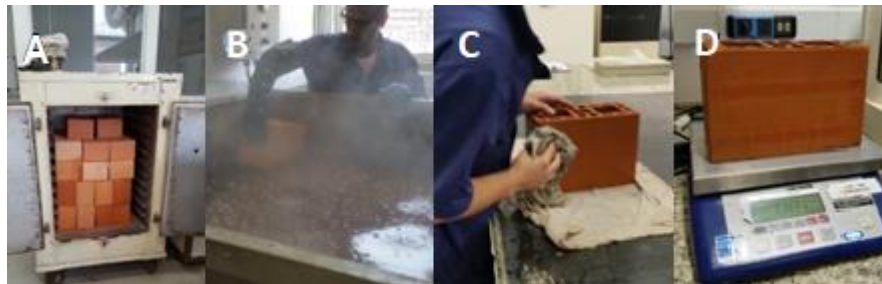
Figura 26- A) Colocação dos blocos em estufa B) Colocação dos blocos em água quente C) Remoção de excesso de água com pano úmido D) Pesagem das amostras úmidas
