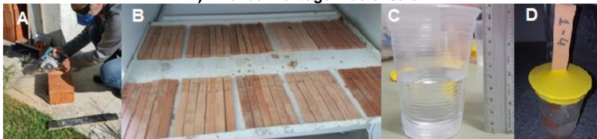
Figura 30- A) Corte das amostras B) Amostras em estufa C) Preparação para o ensaio D) Final da montagem do ensaio
