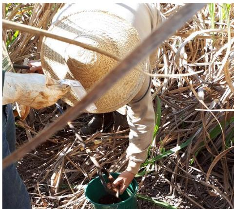
a) perfurando o solo com o trado a 30cm de altura b) dispensando o solo em um recipiente para homogeneizar
