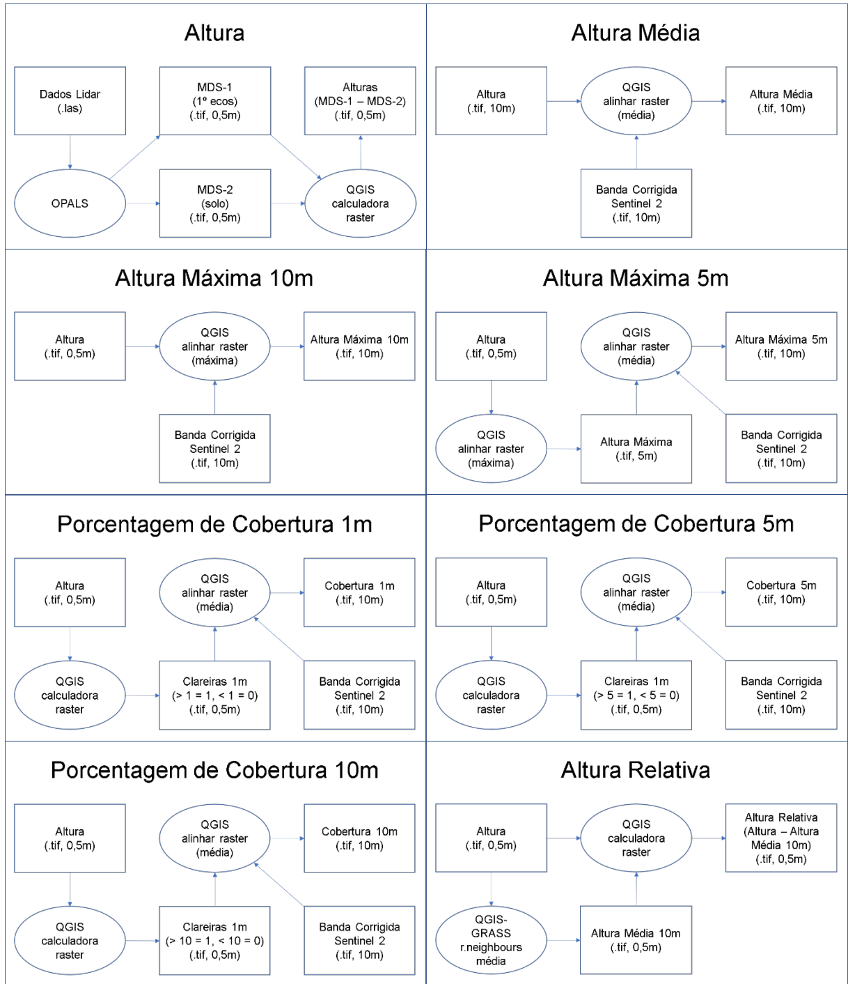
Figura A1: Fluxogramas mostrando os procedimentos utilizados para o cálculo das variáveis LiDAR.
