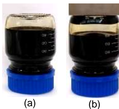
Figura 5-1: Dispersão de nanopartículas (a) sem campo magnético e (b) sob influência de campo magnético.
