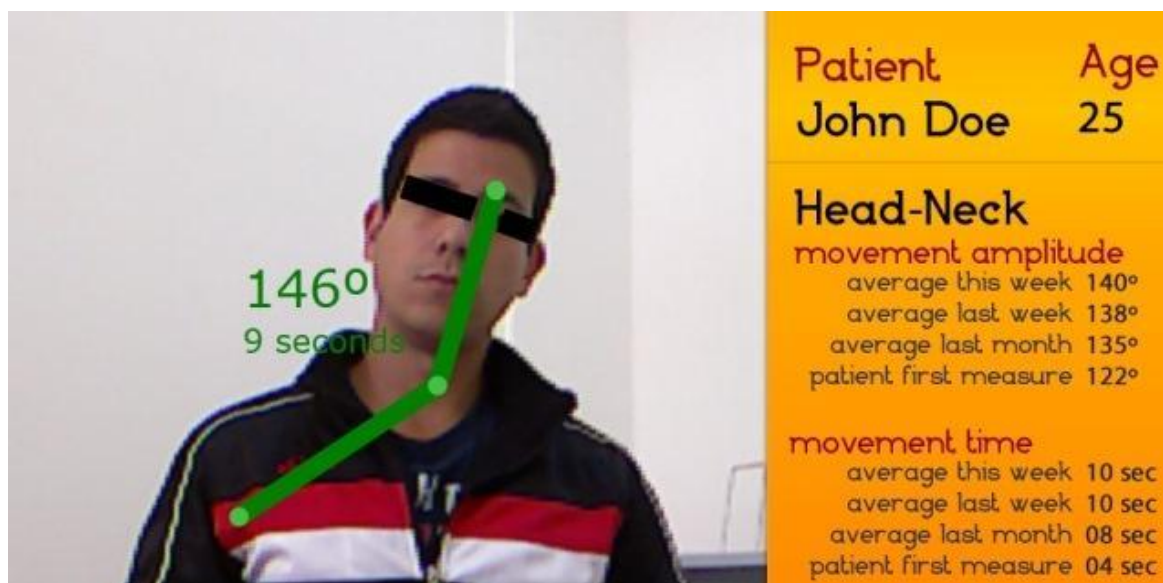
Figura 6 - Primeiro protótipo funcional em detalhes. Objetivava mostrar a amplitude dos movimentos registrada nos pacientes, separando a captura por três grupos de movimentos: pescoço, braços e tronco.
