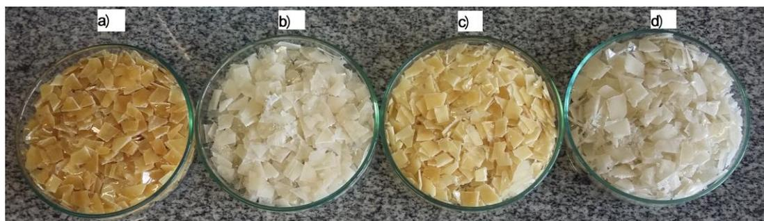
Figura 3.4 - Polímeros modificados, purificados e compactados por fusão utilizados nas blendas PLA/PBAT; a) PLA modificado com anidrido maleico (amostra MA\_1\_2); b) PLA modificado com GMA (amostra GMA\_0,55\_4,11); c) PLA modificado com anidrido maleico (amostra MA\_0,55\_4,11); d) PLA degradado por processamento.
