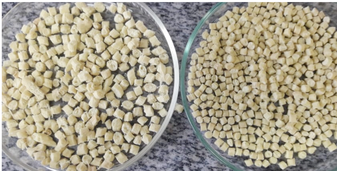
Figura 5.10 - Grãos da condição 2A.2.5 extrudados (esquerda) e do compósito comercial Zytel® 70K20HSL NC010 (direita).
