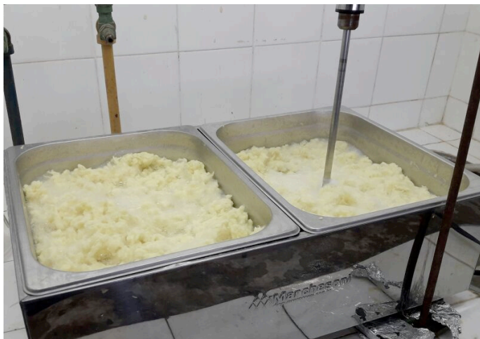
Figura 4.3 - Sistema utilizado para a lavagem com detergente das fibras.
