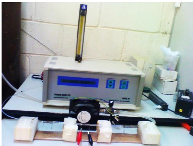
FIGURA 5. 3-Sistema de detecção: Espectrômetro de Fluorescência Atômica do Vapor Frio (CVAFS).
