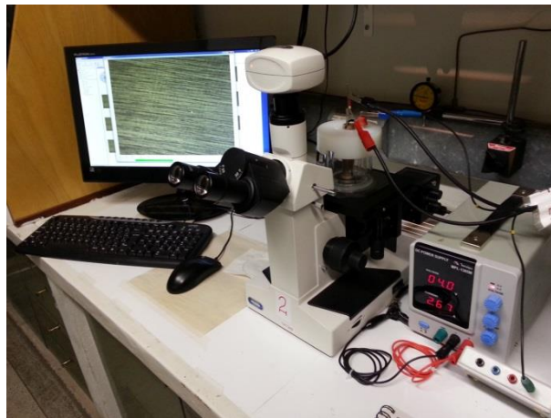
FIGURA 3.5 – Microscópio óptico invertido com o sistema digital de captura e processamento de imagens fotografadas ou filmadas.
