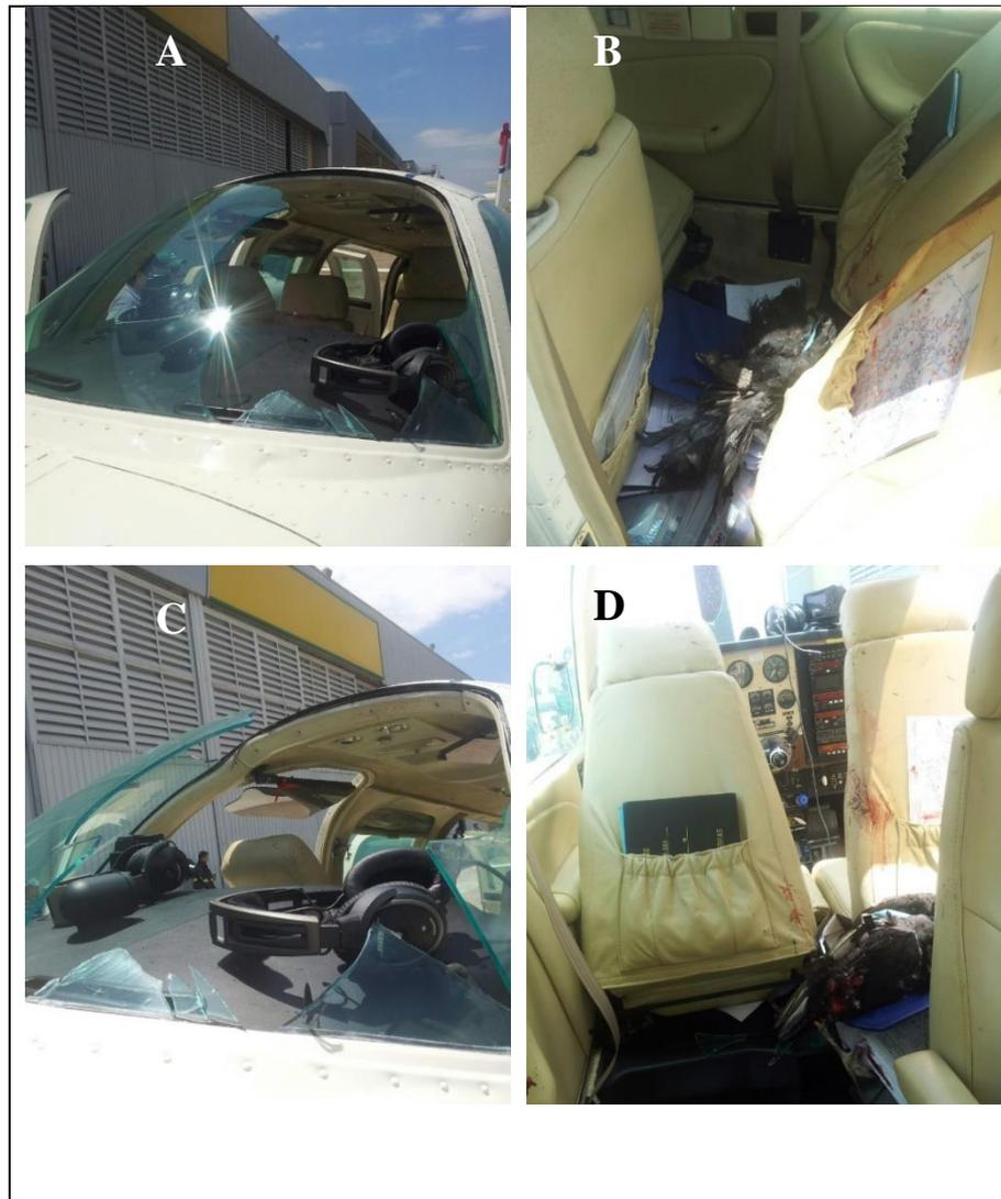
**Figura 4.** Evento envolvendo aeronave de pequeno porte e urubu-de-cabeça-preta no SBPA. A) Aeronave de pequeno porte após colisão com *C. atratus.*; B) Restos de *C. atratus* após colisão com aeronave de pequeno porte; C) Aeronave de pequeno porte após colisão com *C. atratus.*; D) Restos de *C. atratus* e vestígio de sangue em aeronave de pequeno porte após colisão com a fauna.
