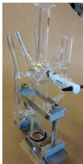
FIGURA 3.1 - Foto das células eletroquímicas utilizadas: a) para preparação das multicamadas metálicas e realização dos experimentos de eletro-oxidação de álcoois e b) para os experimentos espectroscópicos de FTIR in situ .
