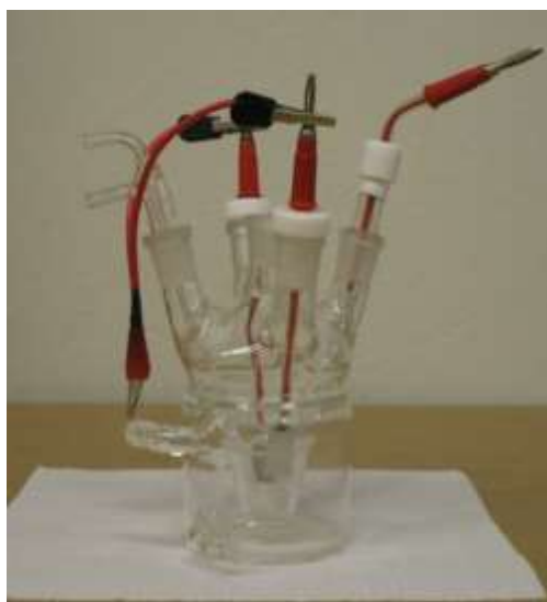
FIGURA 3.1 - Foto das células eletroquímicas utilizadas: a) para preparação das multicamadas metálicas e realização dos experimentos de eletro-oxidação de álcoois e b) para os experimentos espectroscópicos de FTIR in situ .
