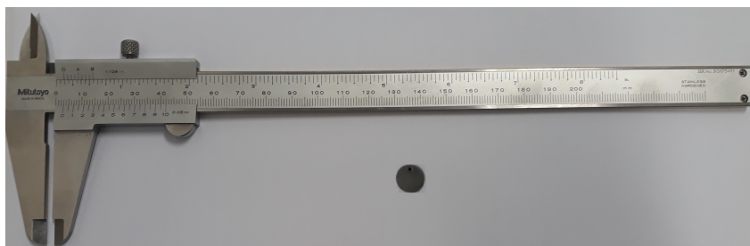
Figura 22: Corpo de prova final para ensaios de corrosão
