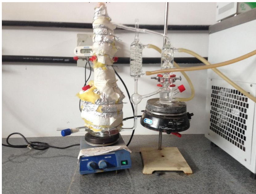
Figura 10 - Ebulliômetro desenvolvido por OLIVEIRA (2003) à pressão atmosférica sem isolamento na célula de equilíbrio
