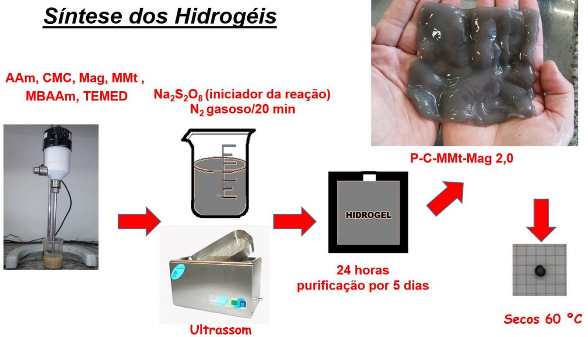
FIGURA 2.2 - Representação esquemática da síntese dos hidrogéis.
