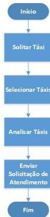
Figura 3.3 Fluxograma Geral o Modelo Básico para Despacho de Táxis
