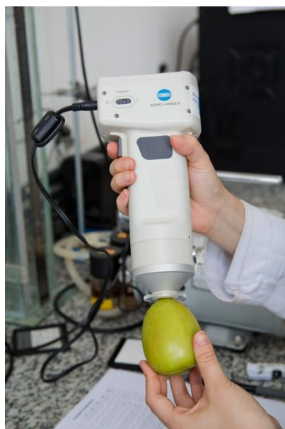
Figura 11. Medição de cor na região basal de cada tomate.
