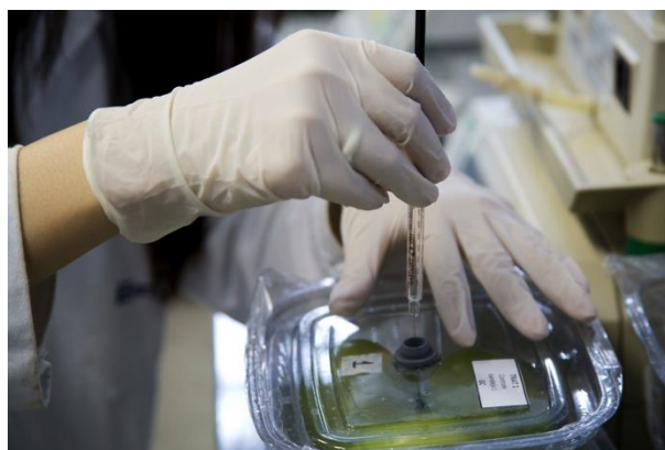
Figura 17. Coleta de 1,0 mL de gás do interior das embalagens, através do septo de silicone.
