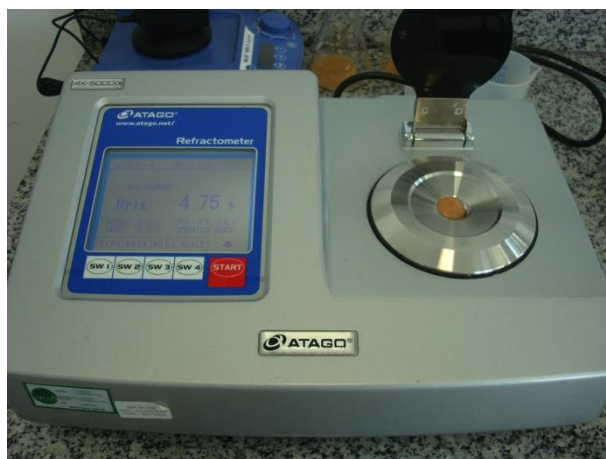
Figura 16. Mensuração do teor de sólidos solúveis com o uso de um refratômetro.
