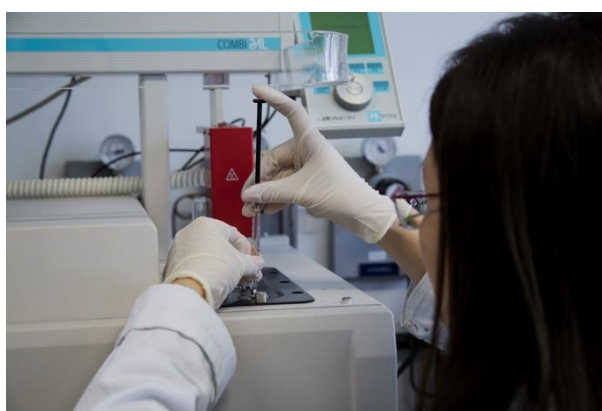
Figura 19. Injeção das amostras de gás em cromatógrafo a gás da marca Varian.
