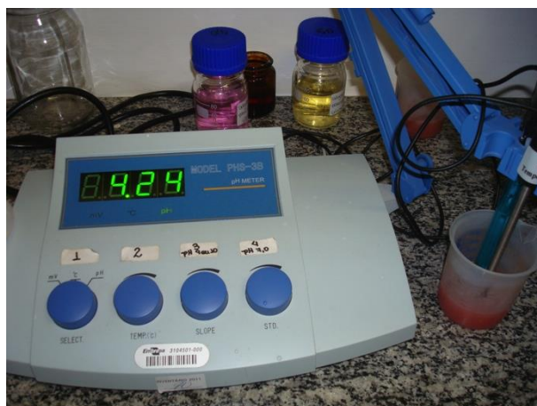
Figura 14. Determinação de pH em pHmetro pela medição direta das amostras trituradas.
