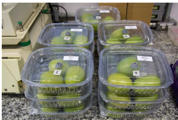
Figura 18. Tomates acondicionados em embalagens plásticas do tipo PET, vedadas com fita adesiva transparente para determinação da composição gasosa.
