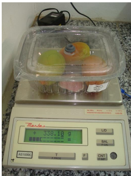
Figura 10. Pesagem dos tomates para o cálculo do percentual de perda de massa fresca.
