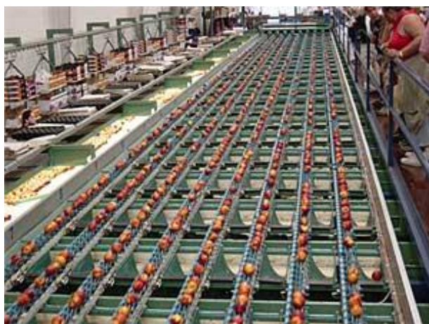
Figura 6. Classificação eletrônica dos tomates por diâmetro e cor na unidade de beneficiamento Santa Cecília, em Cabreúva, SP.
