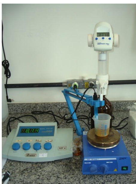
Figura 15. Determinação da acidez titulável das amostras por meio da titulação com NaOH a 0,1 N até atingir pH 8,1.
