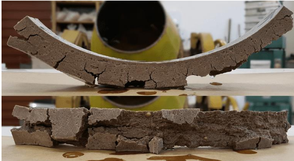
Figura 63 - Amostra de referência submetida à cura térmica e solução de sulfato (a) e amostra de ACBC submetida à cura térmica e solução de sulfato (b) rompidas
