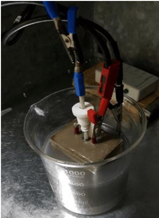
Figura 52 - Montagem da célula eletroquímica no corpo de prova
