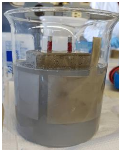
Figura 51 - Corpo de prova imerso em solução saturada de cal e envolto pelo contra-eletródo
