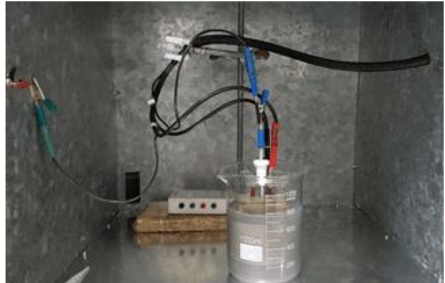
Figura 53 - Célula eletroquímica aterrada na gaiola de Faraday
