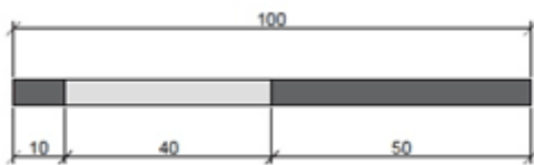
Figura 45 - Modelo da barra de aço com isolamento nas pontas (medidas em mm)
