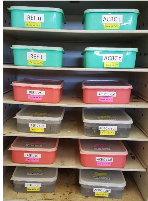
Figura 42 - Recipientes fechados com corpos de prova de ataque por sulfatos na estufa a 40 °C
