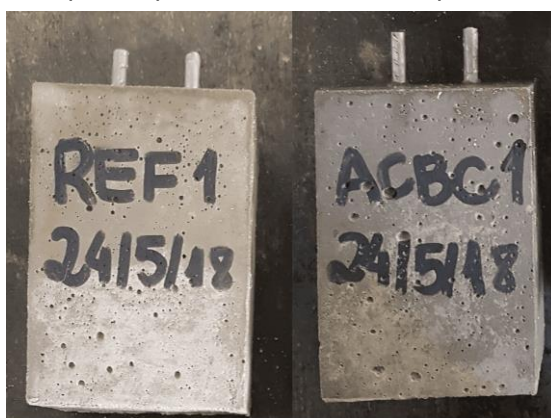
Figura 47 - Corpos de prova com armaduras após a desmoldagem
