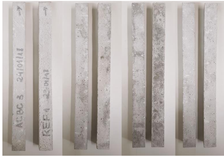
Figura 58 - Faces de um corpo de prova de REF e de 30ACBC após 100 dias submerso em solução de NaOH a 80 °C
