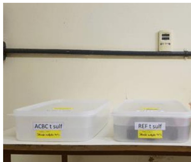
Figura 40 - Recipientes fechados com corpos de prova em cura intermediária de solução de cal a 23 °C
