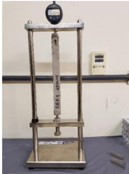
Figura 37 - Medição de comprimento de um corpo de prova do traço de referência
