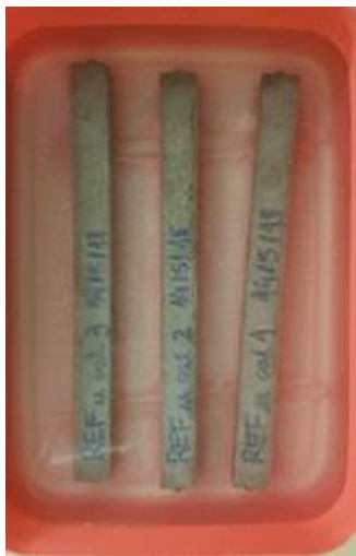
Figura 39 - Corpos de prova do traço de referência em cura intermediária de solução de cal a 23 °C
