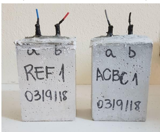
Figura 48 - Corpos de prova com armadura finalizados após o contato elétrico
