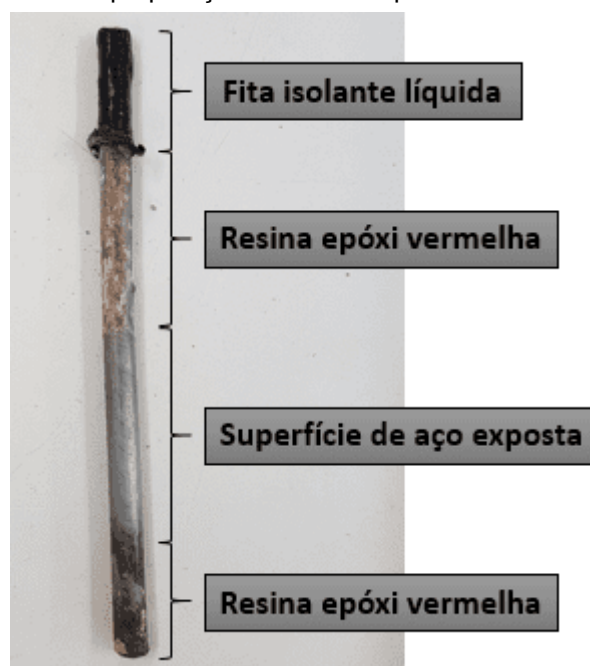
Figura 55 - Barra de aço retirada do CP para preparação de amostra para MEV
