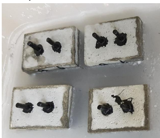
Figura 54 - CPs para realização de MEV em solução saturada de hidróxido de cálcio
