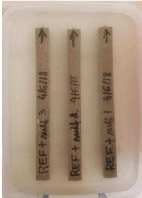
Figura 41 - Corpos de prova de ataque por sulfatos em solução de sulfato a 23 °C
