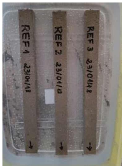
Figura 36 - Corpos de prova do traço de referência imersos em solução de NaOH
