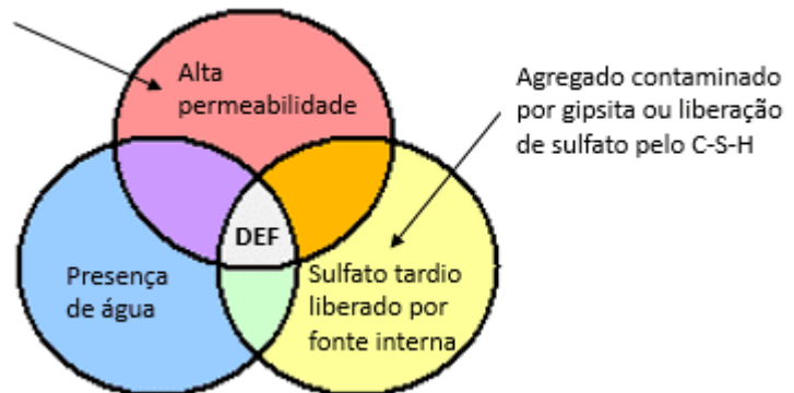
Figura 14 - Formação da etringita tardia (DEF)
