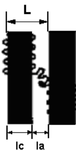
Figura 3.14: Representação do período longo, L , espessura da lamela, l_c , e espessura da camada amorfa, l_a , assumindo-se morfologia bifásica amorfo/cristalina ideal [51].
