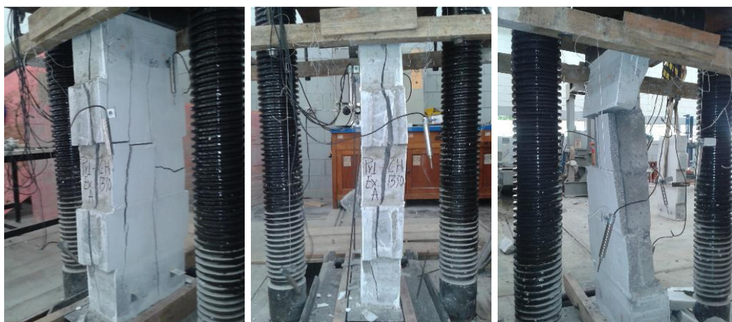
Figura 75 – Prismas grauteados ensaios com carregamento excêntrico –ruptura por tração.
