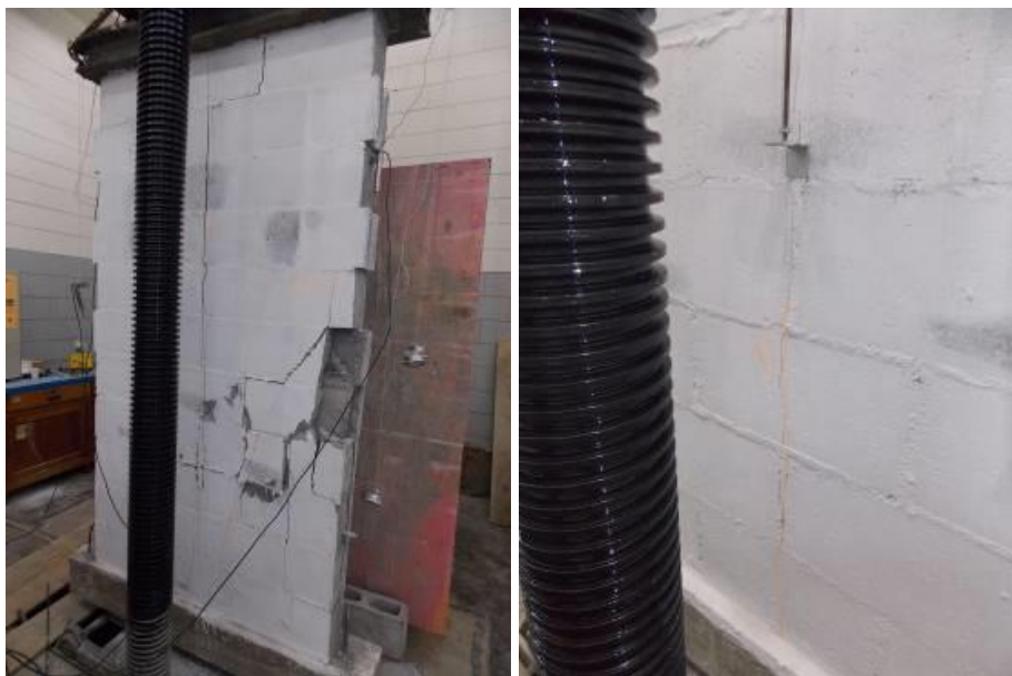
Figura 56. Modo de ruptura das paredes ocas com cinta grauteada
