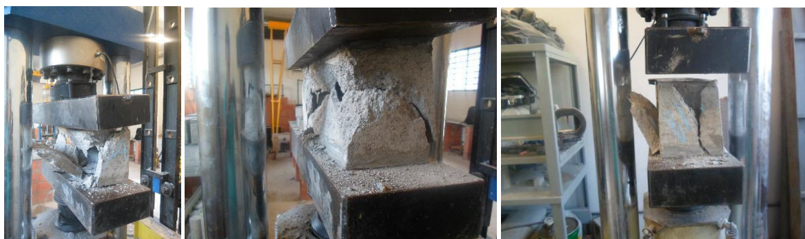
Figura 164. Ensaio do bloco de concreto e o modo de ruptura, Pasta de Cimento
