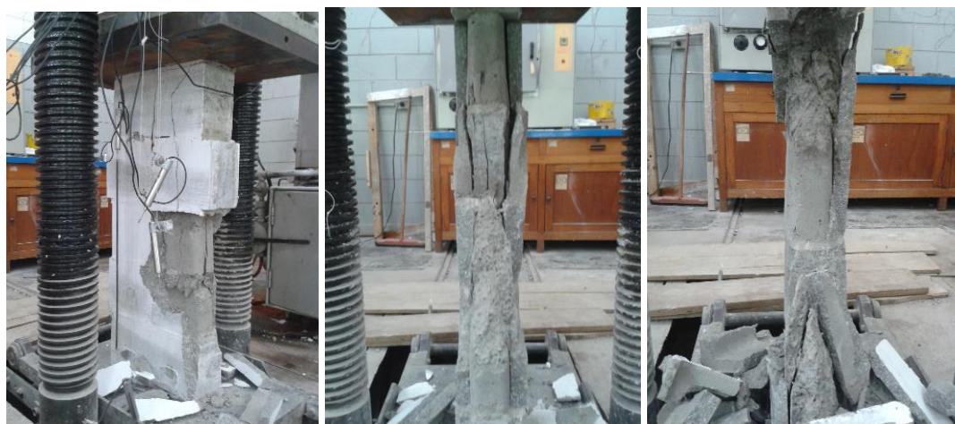
Figura 73 – Prismas grauteados ensaios com carregamento concêntrico – ruptura por compressão.
