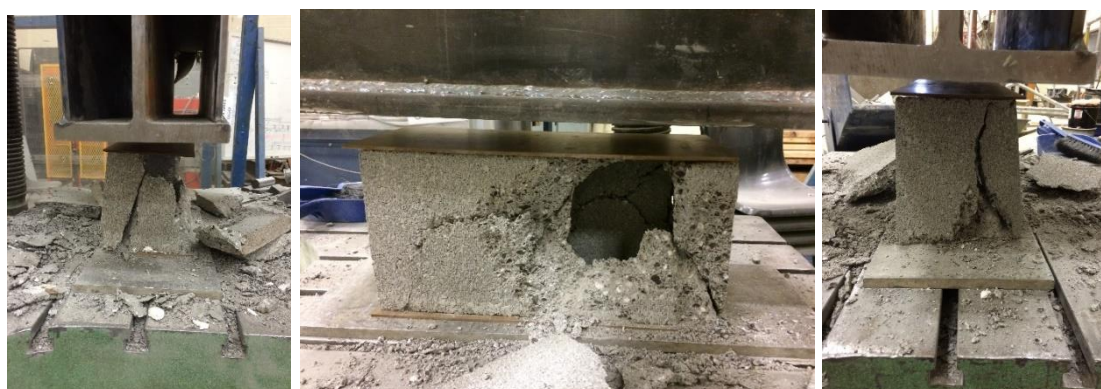
Figura 169. Ensaio do bloco de concreto e o modo de ruptura, Chapa Dura2
