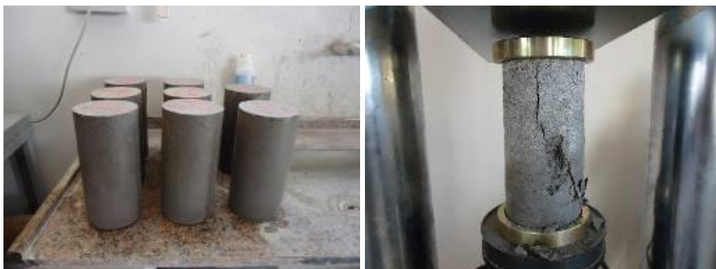
Figura 50. Ilustração dos ensaios dos corpos de provas cilíndricos de grautes
