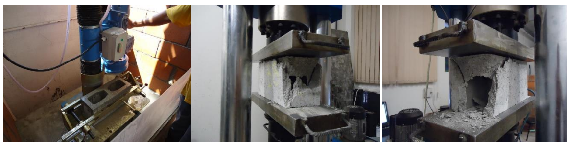
Figura 159– Bloco de concreto capeado e o modo de ruptura, Retifica
