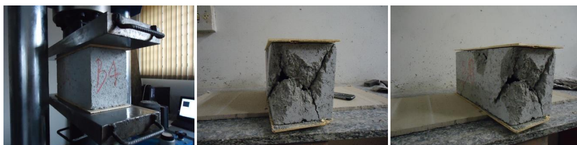
Figura 158– Bloco de concreto capeado e o modo de ruptura, Compensado
