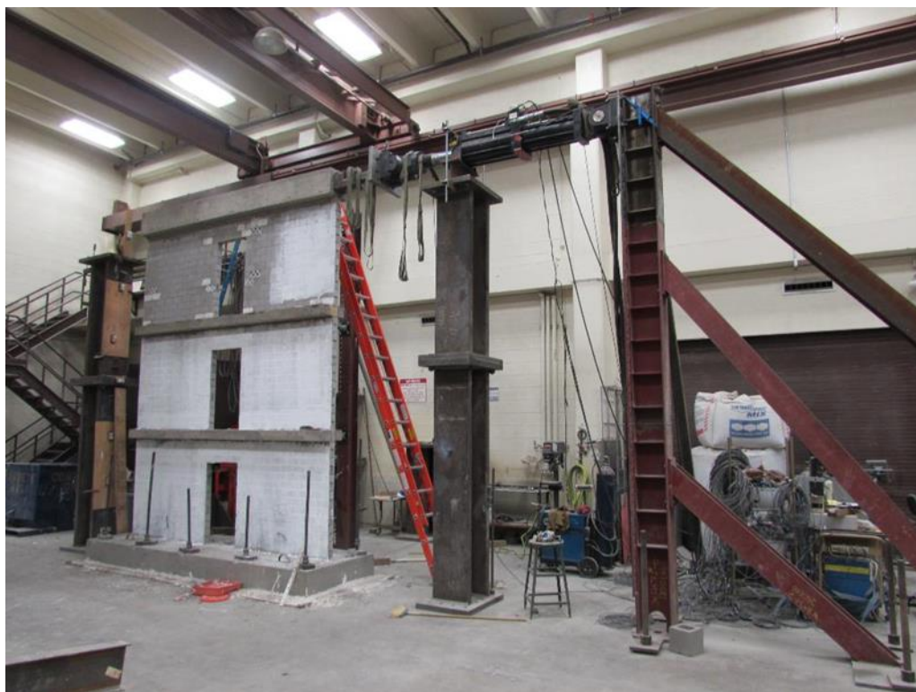
Figura 99– Ilustração do Sistema de aplicação da carga lateral no plano da parede
