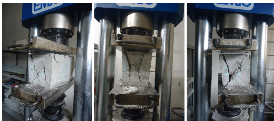
Figura 160– Bloco de concreto capeado e o modo de ruptura, Pasta de Cimento
