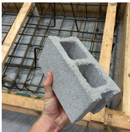
Figura 77- \frac{1}{2} escala de blocos de concreto
