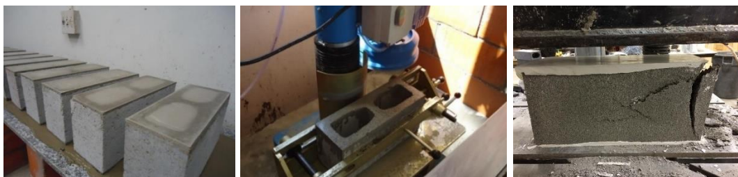
Figura 153- Procedimentos de capeamento normatizados, respectivamente, Pasta de Cimento; Retífica; e Pasta de Gesso.
