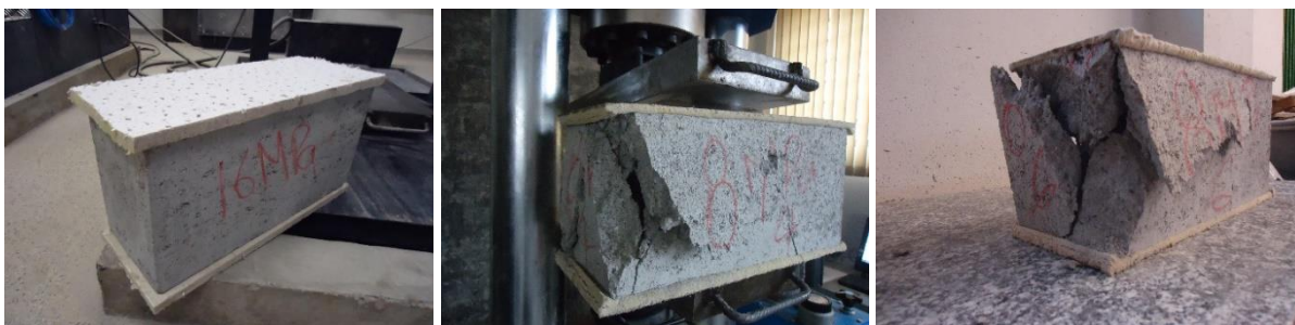
Figura 157– Bloco de concreto capeado e o modo de ruptura, Forro Pacote
