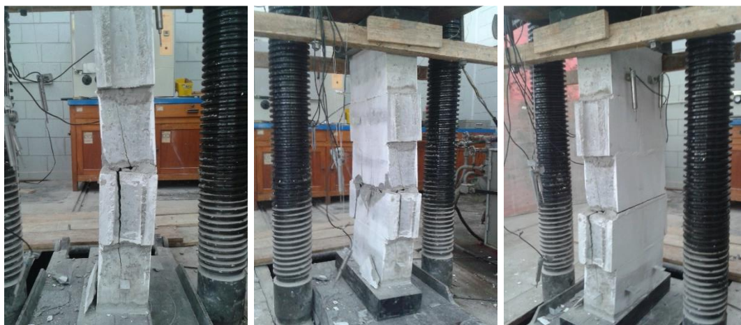
Figura 74 – Prismas ocos ensaios com carregamento excêntrico – ruptura pela combinação de compressão-tração.
