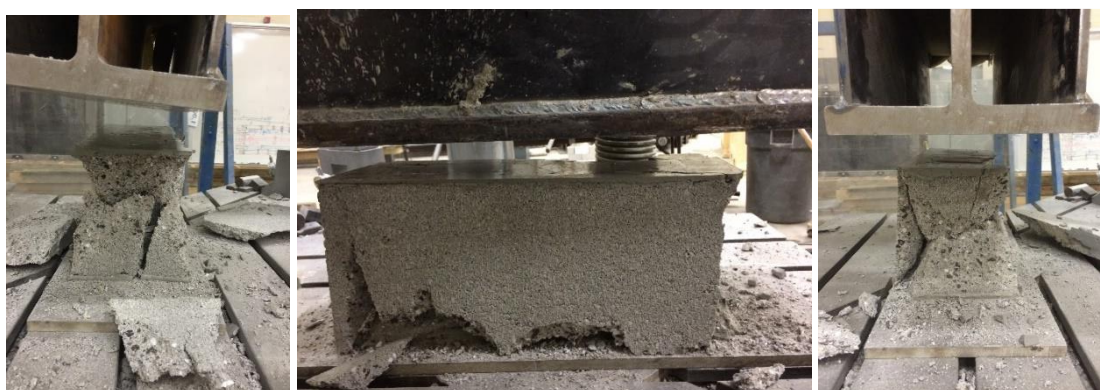
Figura 171. Ensaio do bloco de concreto e o modo de ruptura, Pasta de Cimento
