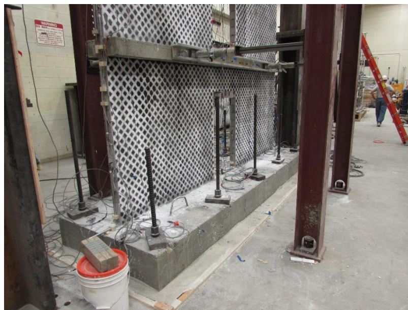
Figura 101 - Ilustração da base de fundação das paredes ensaiadas piso do laboratório.
