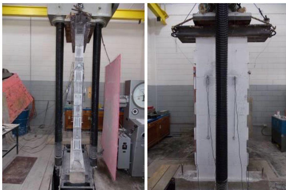
Figura 45. Configuração do ensaio das paredes, grupo 1 e 2.
