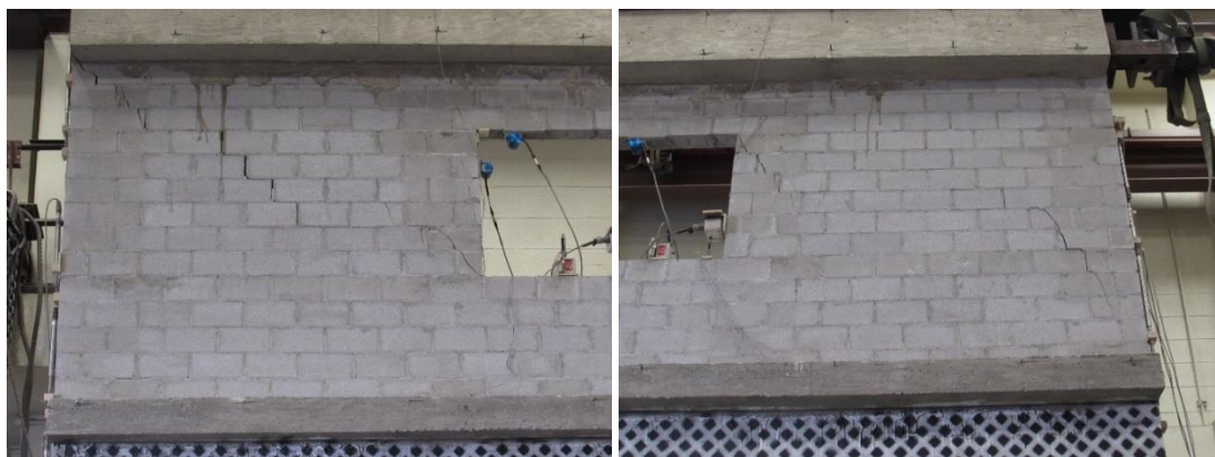
Figura 108 –Forma de ruptura da parede 1 dotada de abertura de janela e acoplada por viga de alvenaria
