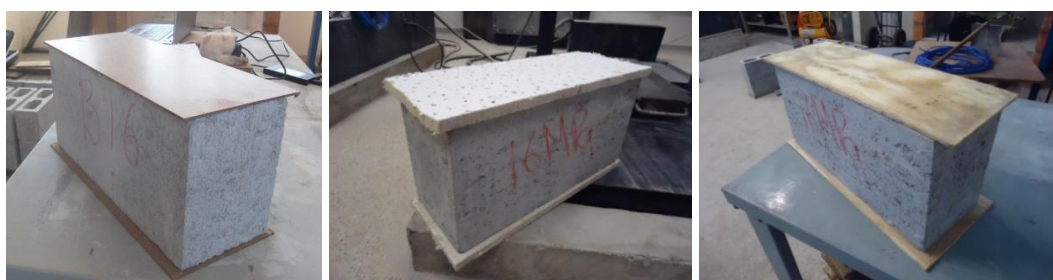
Figura 152– Material de capeamento Seco no topo dos blocos, respectivamente, Chapa Dura 1; Forro Pacote; e Compensado.
