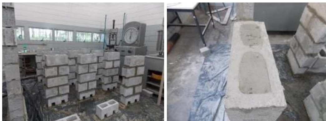
Figura 36. Ilustração dos prismas ocios e grauteados
