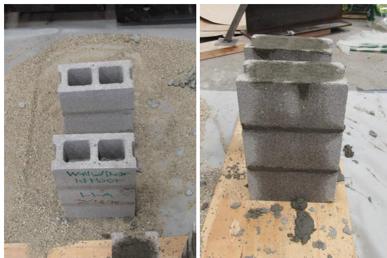
Figura 95 – Construção e grauteamento dos prismas
