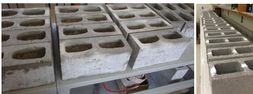
Figura 154- Bloco de alvenaria de concreto típico.
