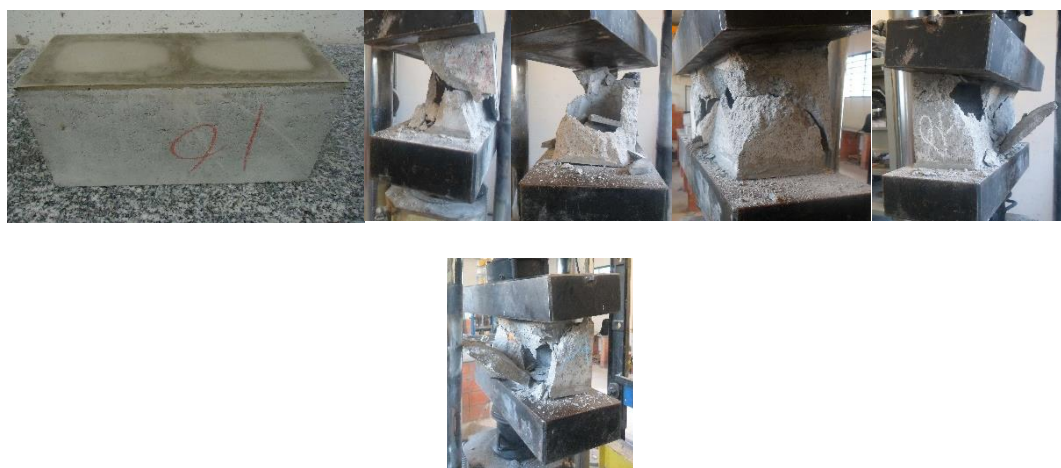
Figura 20. Ilustração do capeamento dos prismas e modo de ruptura do bloco
