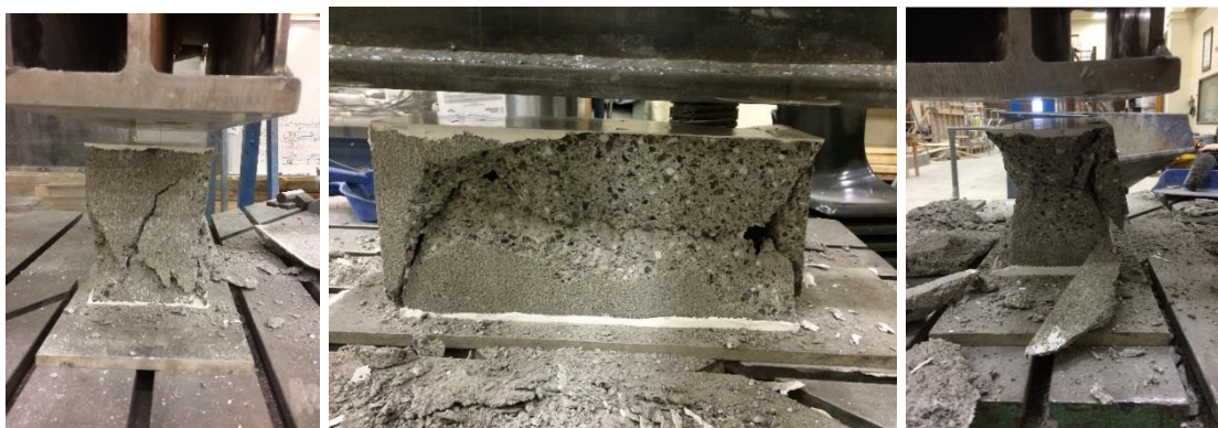
Figura 170. Ensaio do bloco de concreto e o modo de ruptura, Gesso
