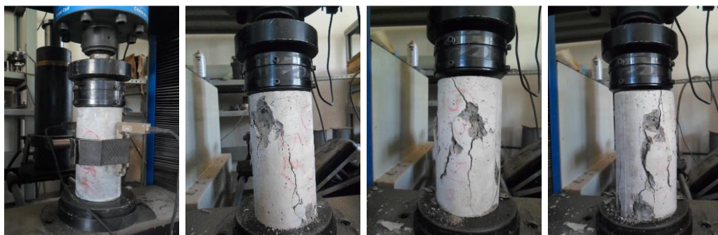
Figura 68- Corpo de prova do graute e modos de ruptura
