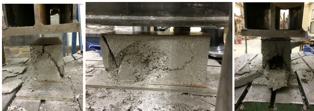
Figura 168. Ensaio do bloco de concreto e o modo de ruptura, Chapa Dura1
