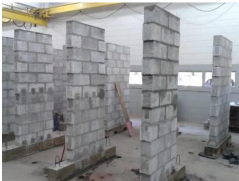
Figura 31. Ilustração das paredes ensaiadas.
