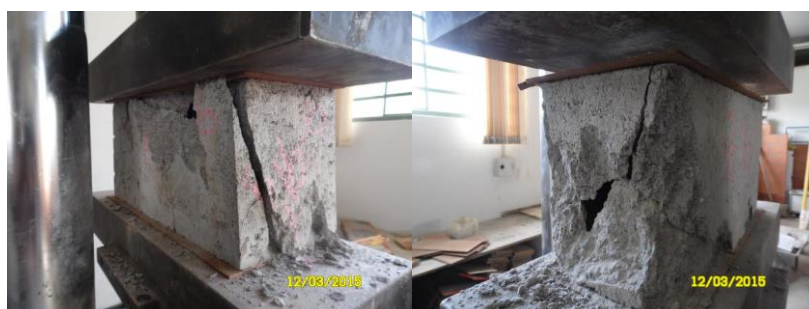
Figura 166. Ensaio do bloco de concreto e o modo de ruptura, Chapa Dura
