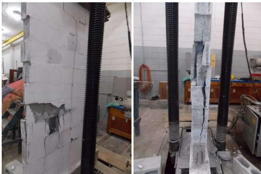
Figura 58. Ilustração da ruptura com fissuração vertical e esmagamento da alvenaria.
