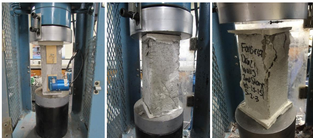
Figura 93 – Ensaio dos prismas de graute e o modo de ruptura.
