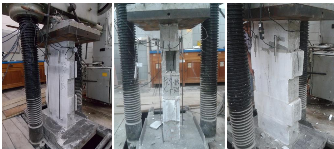
Figura 72– Prismas ocos ensaios com carregamento concêntrico – ruptura por compressão.
