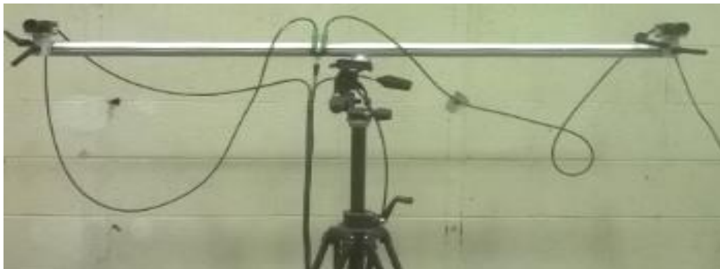
Figura 144 – Ilustração das câmeras utilizadas no DIC.
