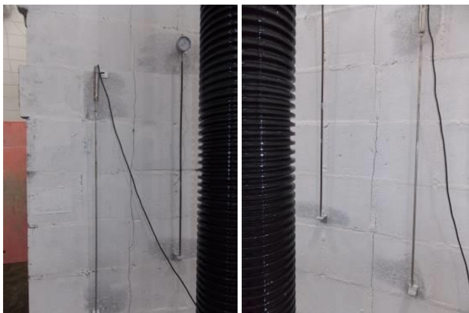
Figura 57 - Ilustração da ruptura das paredes ocas
