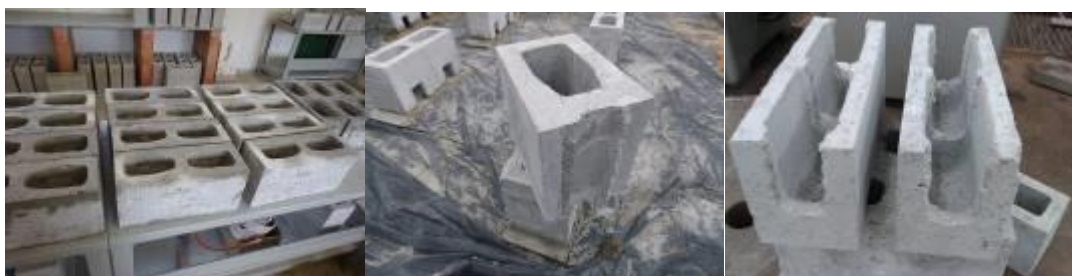
Figura 32. Ilustração dos blocos de concreto inteiros e cortados, e as canaletas utilizadas.
