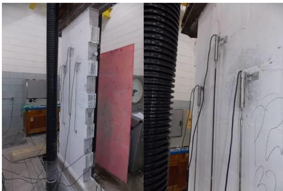
Figura 47. Instrumentação das paredes.
