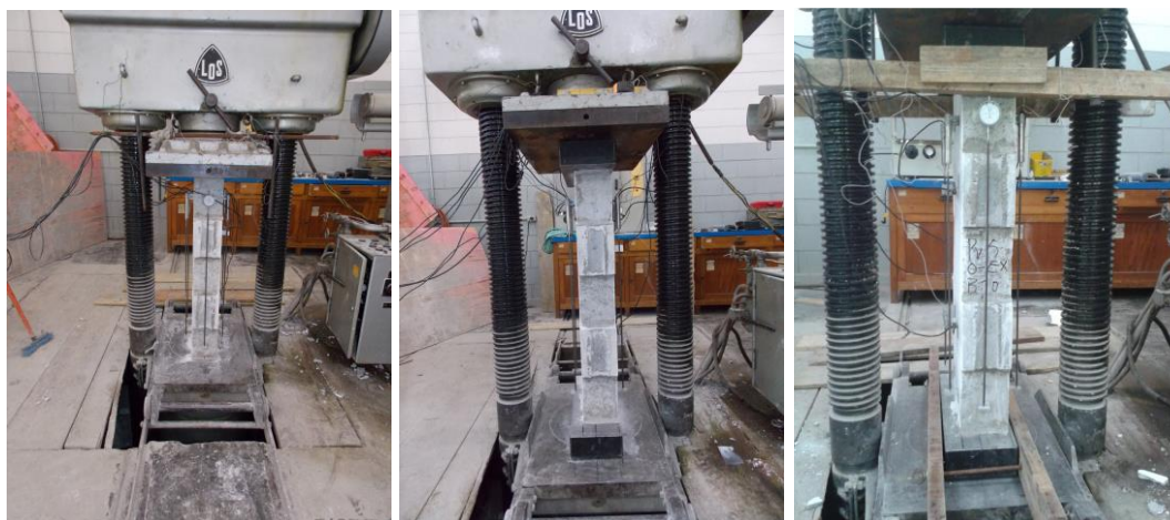
Figura 62– Ensaio do prisma.
