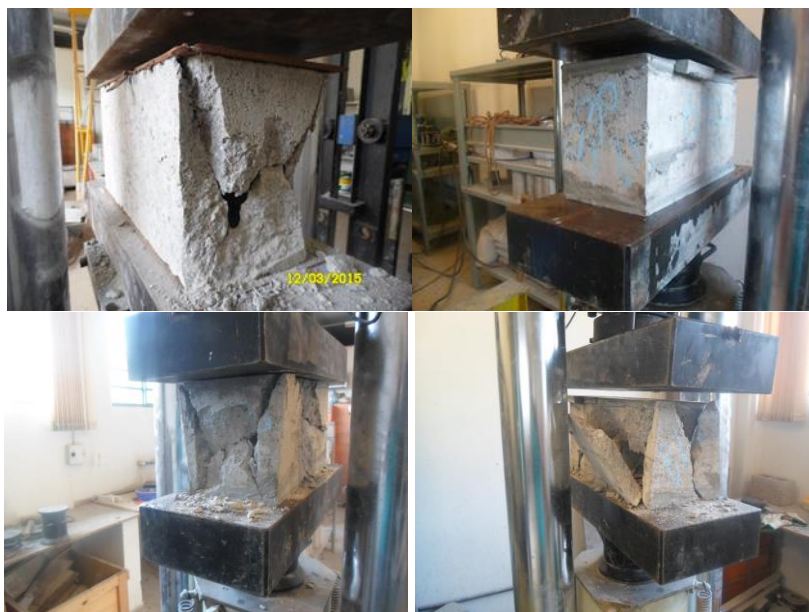
Figura 167. Ensaio do bloco de concreto e o modo de ruptura, Pasta de Cimento
