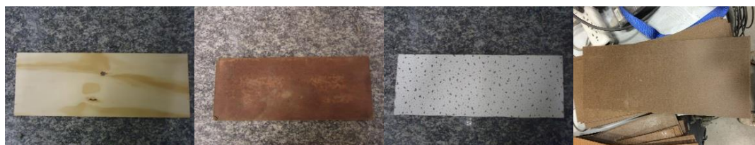
Figura 151– Material de capeamento Seco, respectivamente, Compensado; Chapa Dura 1; Forro Pacote; e Chapa Dura 2.
