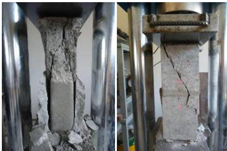
Figura 51. Ilustração dos ensaios prismas ocós e grauteados.
