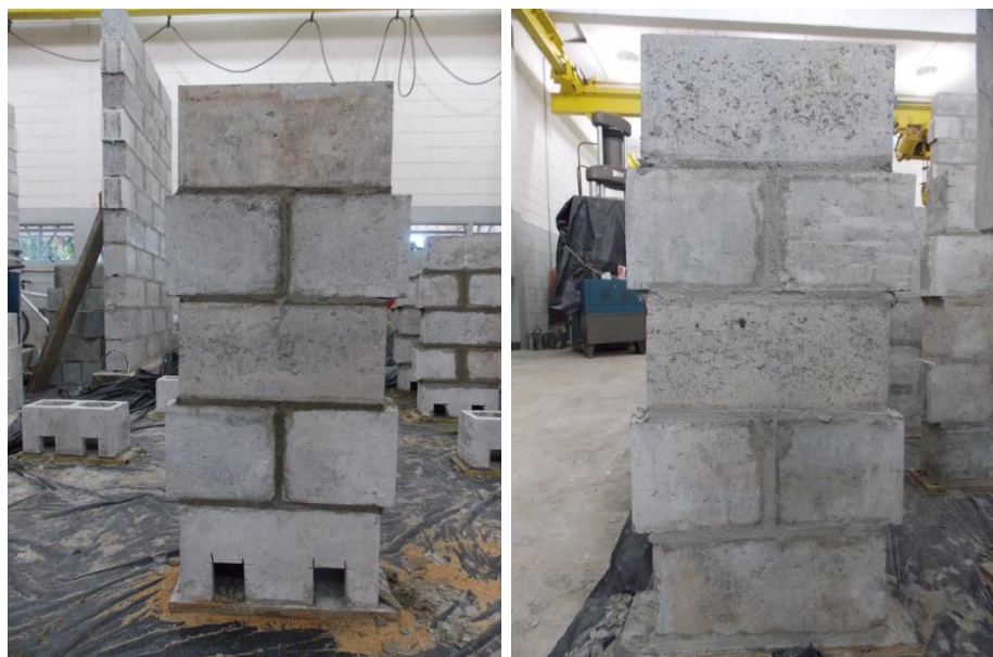
Figura 61– Configuração dos prismas grauteados e ocos
