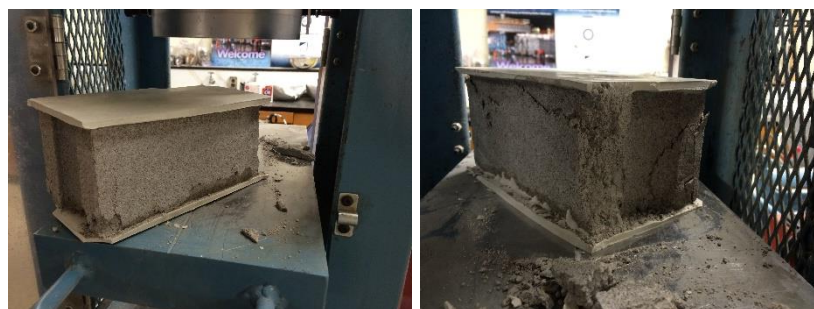
Figura 94 – Ilustração do ensaio dos blocos de concretos, escala ½.
