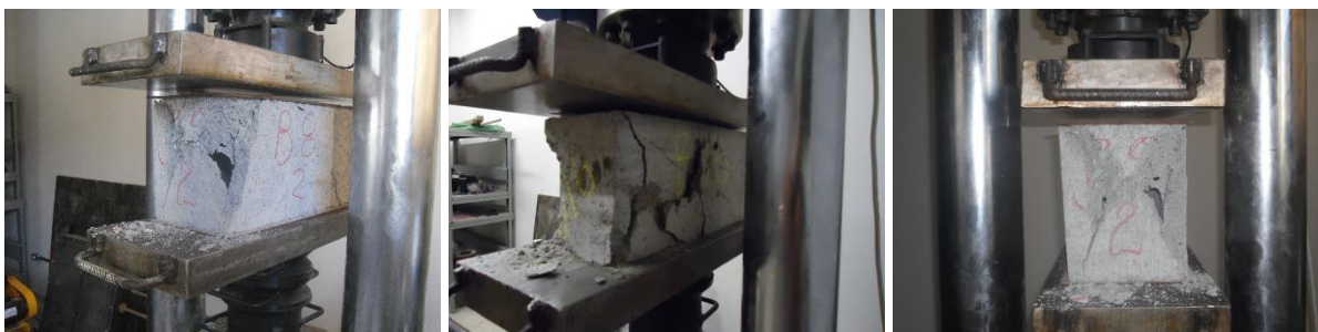
Figura 163. Ensaio do bloco de concreto e o modo de ruptura, Chapa Dura 1
