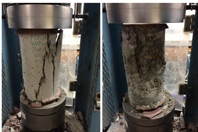
Figura 91 – Ensaio dos cilíndricos de concreto – Concreto de fundação
