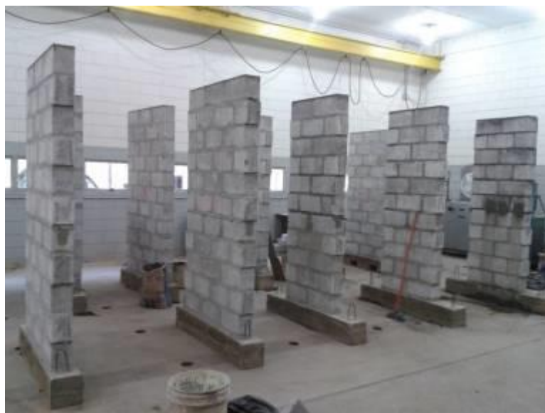
Figura 44. Ilustração das paredes construídas para os ensaios de compressão.
