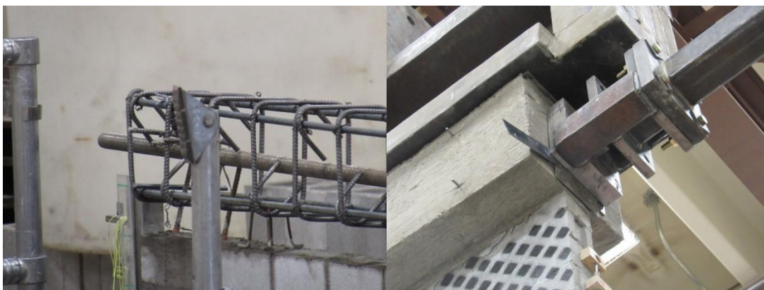
Figura 98– Conexão atuador de carga-parede
