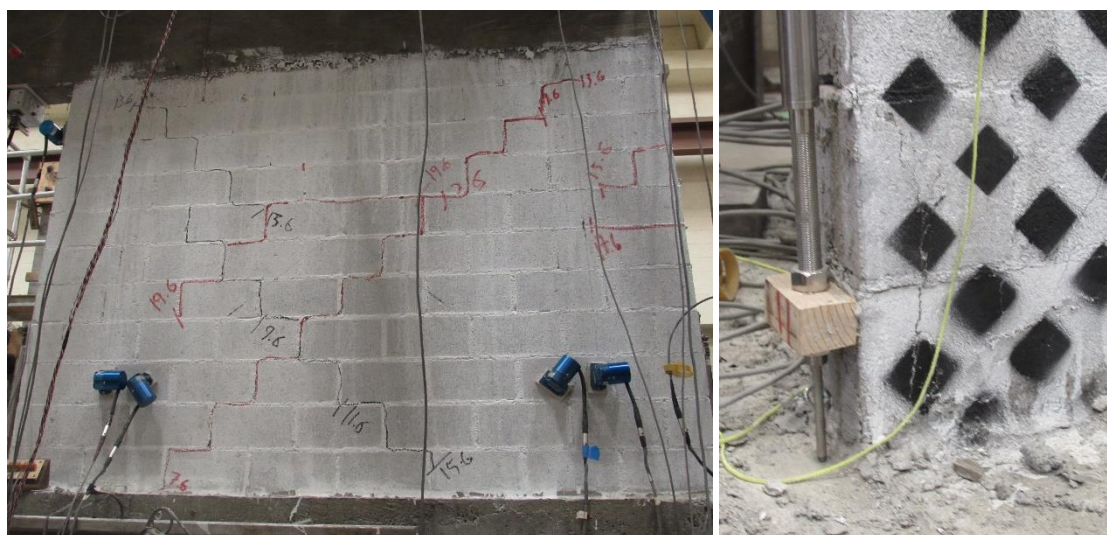
Figura 104– Instrumentação montada nas paredes antes do ensaio
