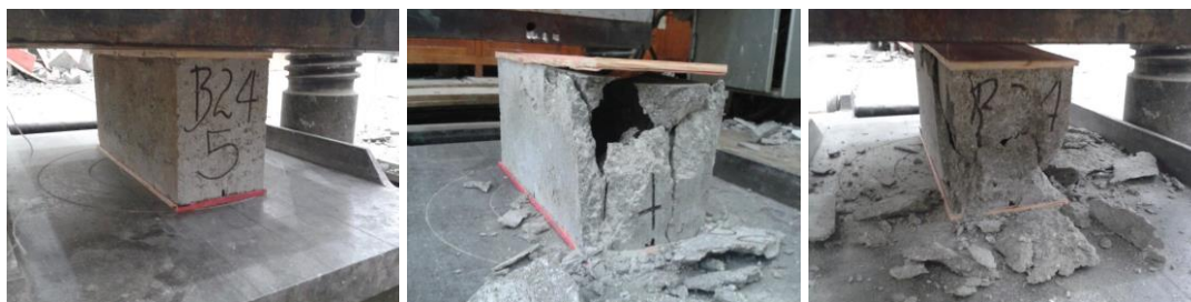
Figura 66- Bloco capeado e modo de ruptura
