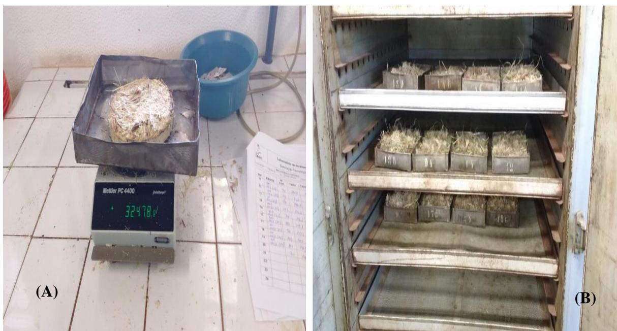
**Figura 33.** Determinação do PBU (Peso do Bolo Úmido) (A); determinação do PBS (Peso do Bolo Seco) (B), para cálculo do teor de Fibra.
