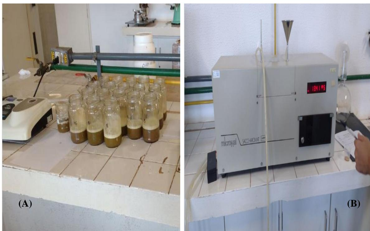
**Figura 32.** Leitura do °Brix em refratômetro de bancada (A); Leitura da Pol em sacarímetro digital (B).
