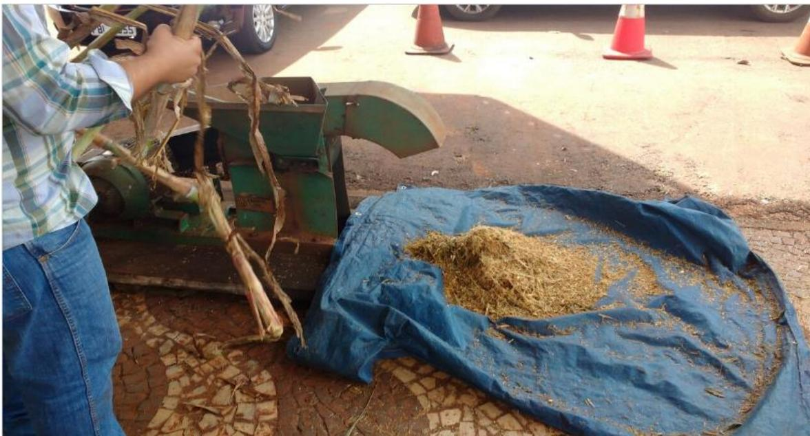
**Figura 30.** Processamento das amostras em máquina forrageira para determinação de matéria seca, umidade e teores nutricionais da parte aérea.
