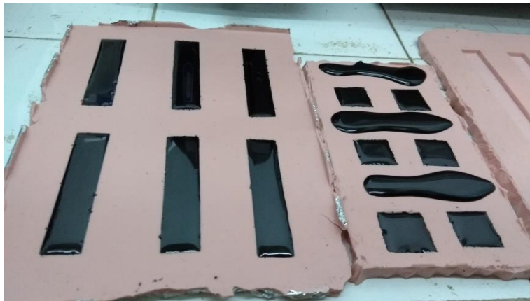
Figura 4.6 Moldes de silicone com os nanocompósitos de epóxi/nanotubos de carbono/cargas minerais. À esquerda estão os corpos de prova de DMTA e a direita os corpos de prova de condutividade.
