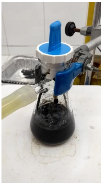
Figura 4.5 Kitasato com o nanocompósito não curado durante o processo de desgaseificação.
