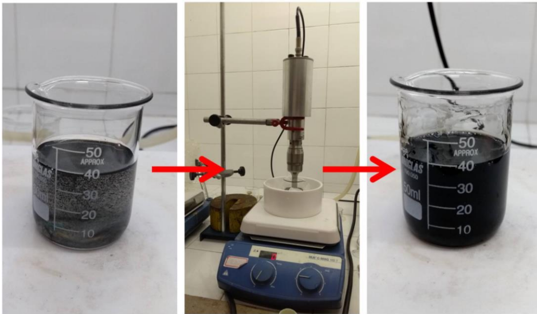
Figura 4.4 Aparência da dispersão dos nanotubos de carbono na resina epóxi antes e depois do processo de sonicação. No processo, utilizou-se um agitador magnético para homogeneizar a amostra e um banho de gelo para evitar superaquecimento.
