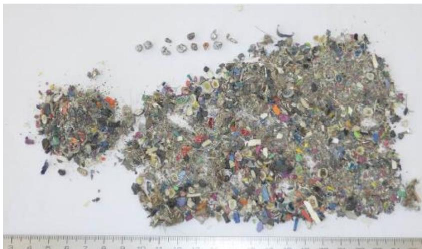
FIGURA 5.4. Imagem da amostra C1 antes do início dos ensaios de moagem.
