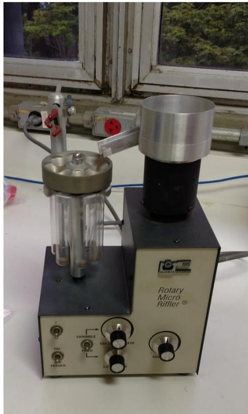
FIGURA 3.9. Foto do equipamento quarteador mecânico Rotary Micro Riffler realizada no laboratório do Instituto Paulista de Tecnologia.
