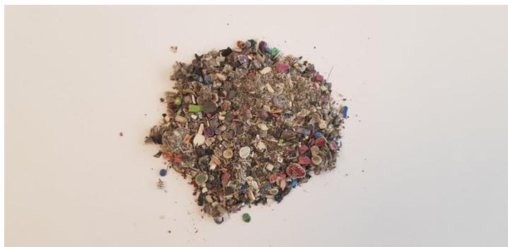
FIGURA 4.2. Amostra previamente triturada apresentando granulometria menor que 5,0 mm.
