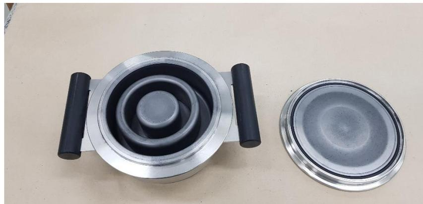
FIGURA 3.2. Conjunto de moagem utilizado no moinho de copo vibratório.
