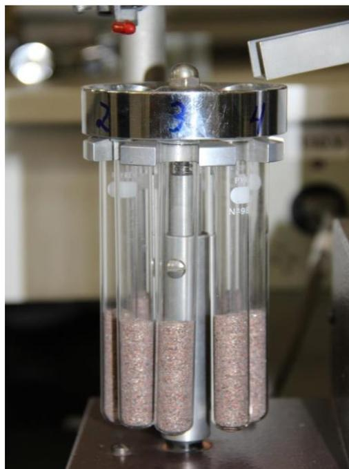
FIGURA 3.10. Foto do sistema rotativo com os 8 tubos de vidro preenchidos com amostras após quarteamento.
