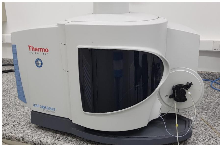
FIGURA 3.12. Espectrômetro de emissão óptica com plasma acoplado indutivamente, modelo iCAP 7400 DUO, do fabricante Thermofischer.
