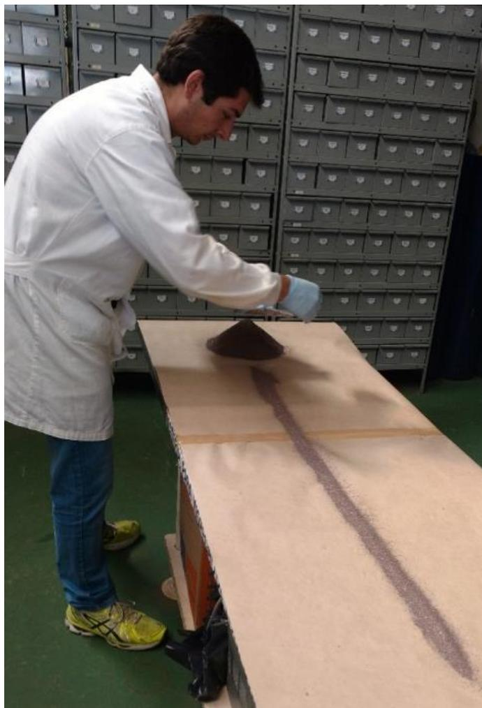
FIGURA 5.8. Distribuição de amostra de 2,5 kg em pilha longitudinal piramidal.
