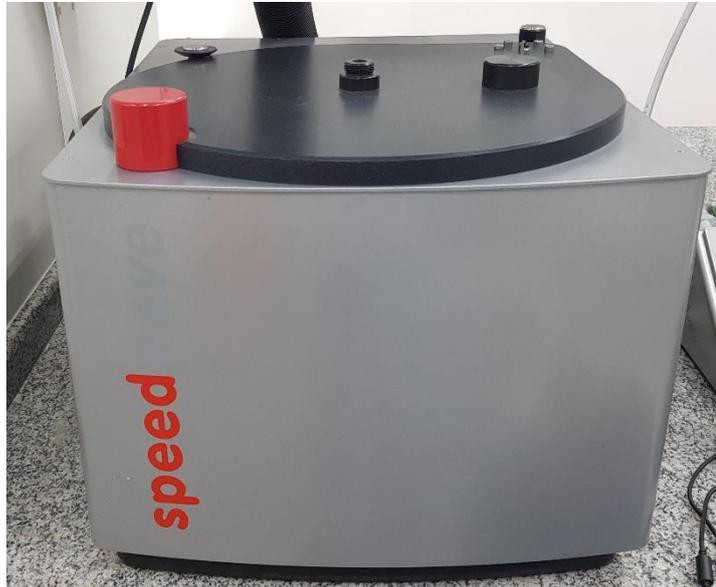
FIGURA 3.11. Digestor de amostras assistido por radiação micro-ondas, Speedwave Four, do fabricante Berghof.
