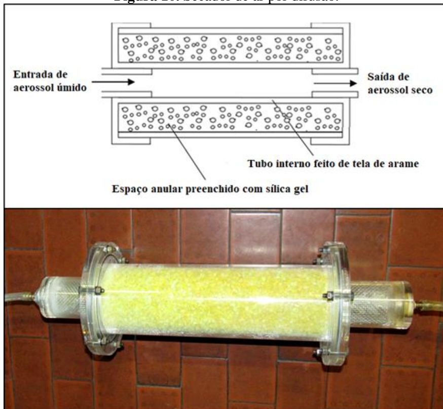
Figura 10. Secador de ar por difusão.
