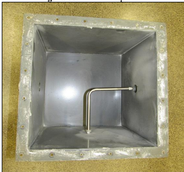
Figura 68. Interior do plenum.
