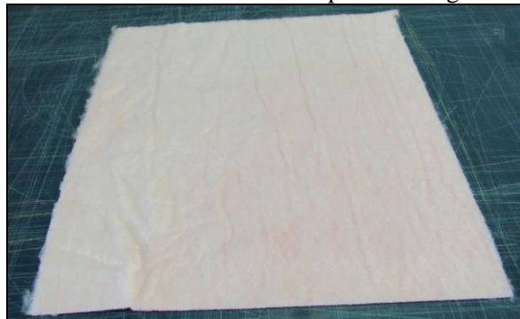
Figura 35. Amostra do meio filtrante do tipo F7 carregado/d Descarregado.
