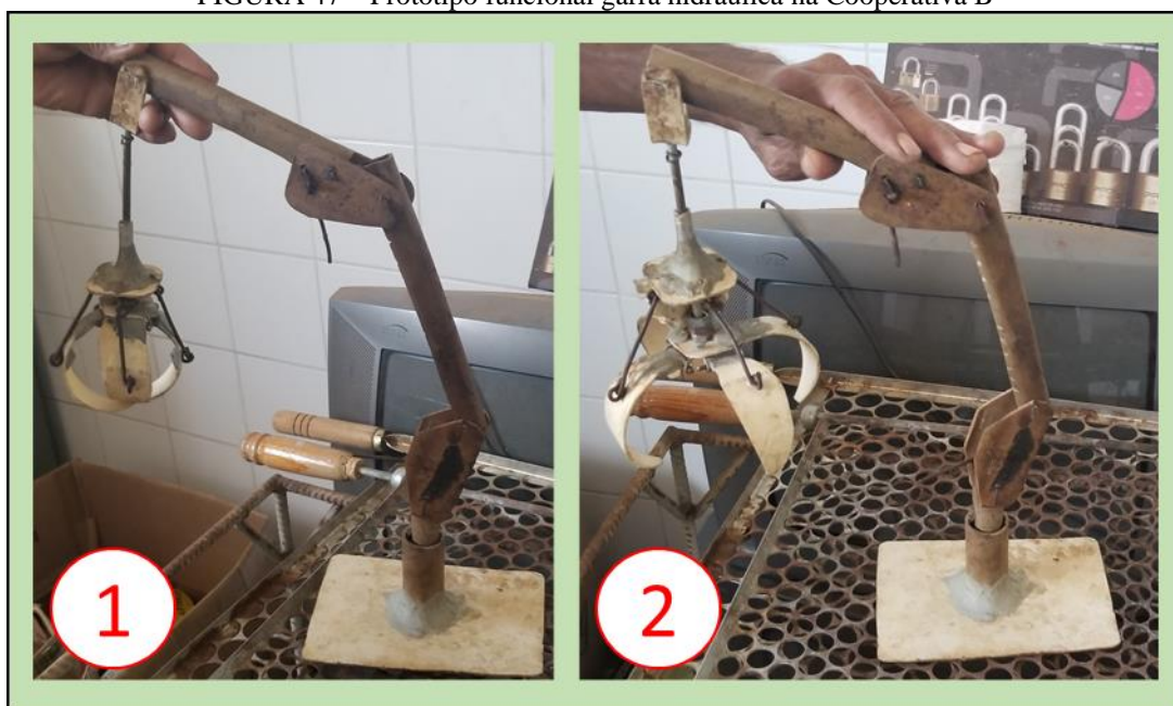
FIGURA 47 – Protótipo funcional garra hidráulica na Cooperativa B
