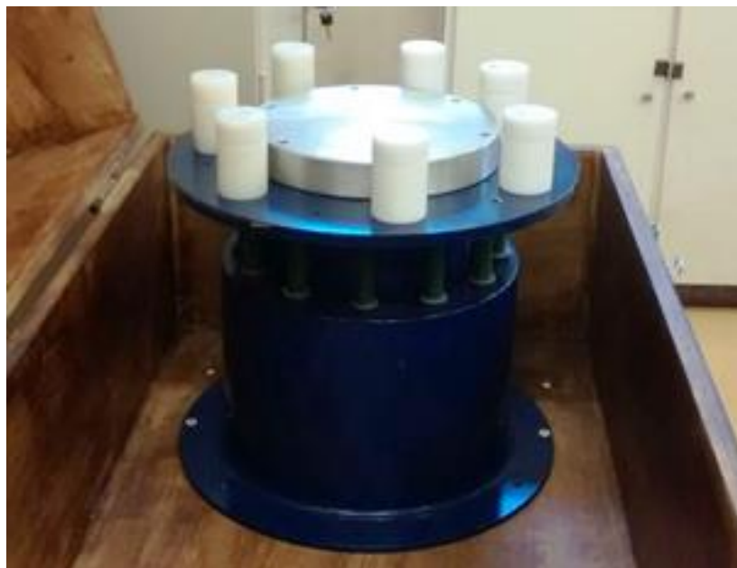
Figura 4. 1: Moinho vibratório de alta energia.
