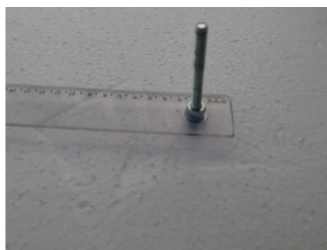
Figura07. Fixar o parafuso com arruela e porca em uma das extremidades da régua.
