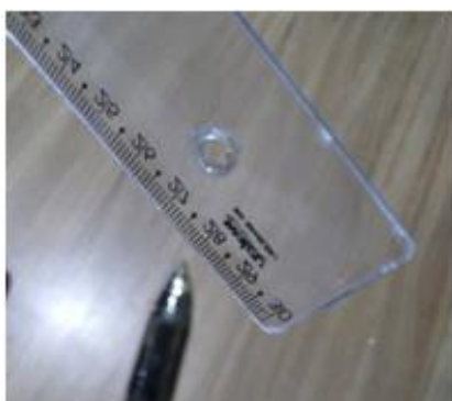
Figura06. Fazer dois furos na régua de 30 cm nas duas extremidades. Utilizar um ferro de solda.
