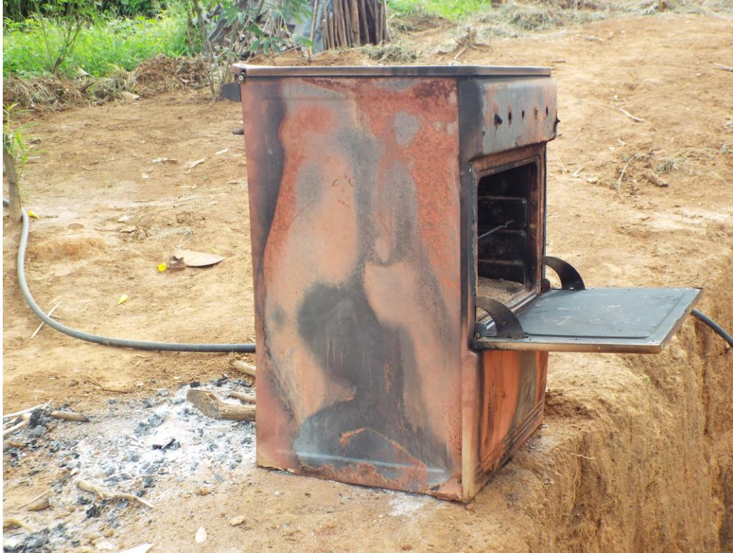
FOTO 3: Fogão à gás adaptado por Izaque para funcionar à lenha.
