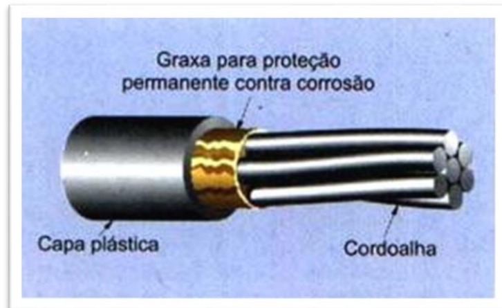
Figura 3-4 - Cordoalhas engraxadas, seus detalhes.
