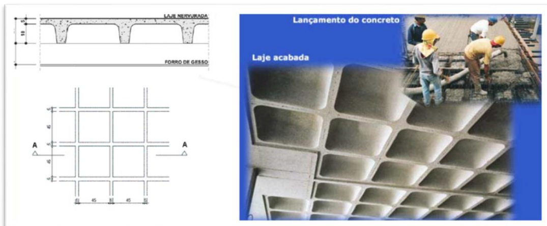
Figura 2-18 – Esquema de laje nervurada tipo cubeta.
