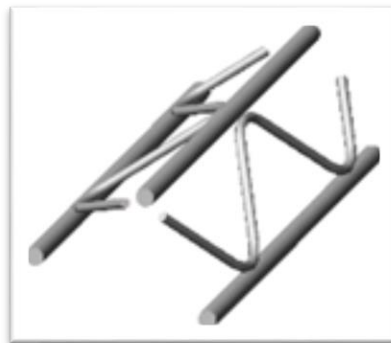
Figura 2-9 – Armadura da nervura da laje tipo treliça.
