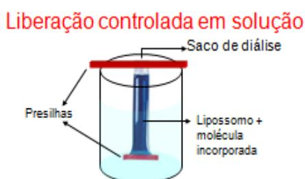
**Figura 11.** Aparato para a análise da liberação de Aloína incorporada em lipossomos.
