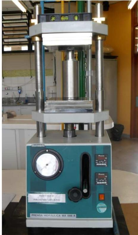
**Figura 2.4 – Conjunto prensa hidráulica e molde utilizado na compactação.**
