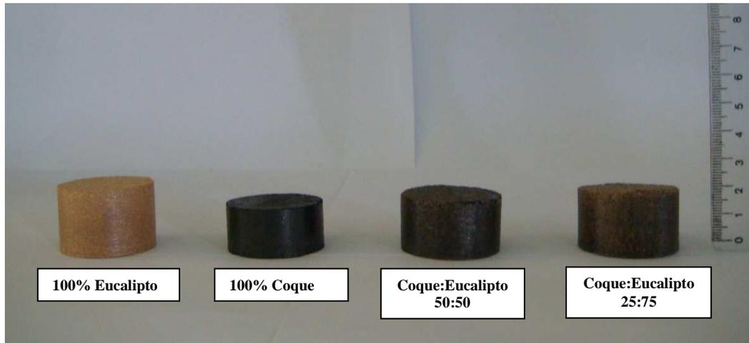
**Figura 2.5 – briquetes com composições de coque e fibras de eucalipto**
