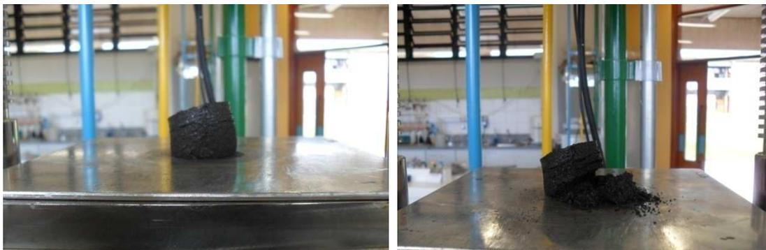
Figura 2.7 – Briquetes com baixa compactação
