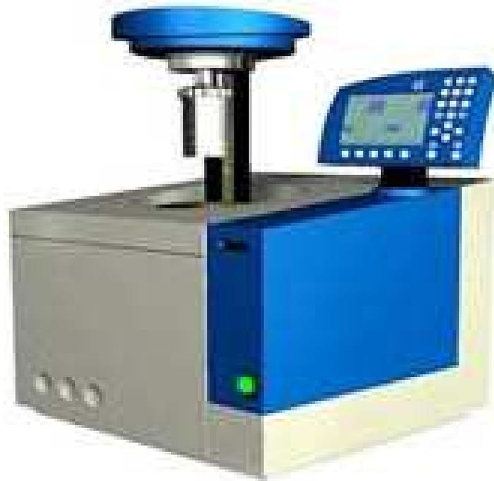
Figura 1.3 – Calorímetro modelo C2000, marca IKA.
