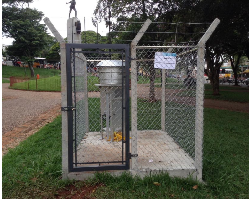
Figura 8-Equipamento (AGV-MP 10 ) na Praça dos Voluntários
