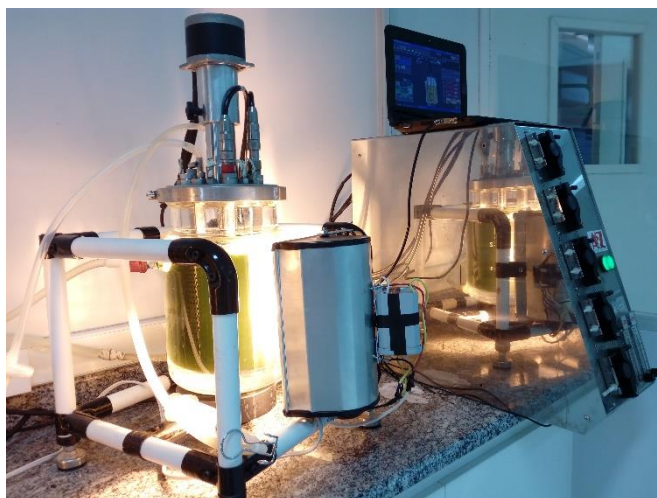
Figura 6. Biorreator de bancada usado para cultivo mixotrófico de D. subspicatus .
