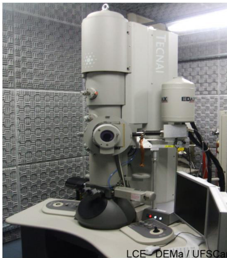
Figura 4. 4: Microscópio Eletrônico de Transmissão do Laboratório de Caracterização Estrutural (LCE)
