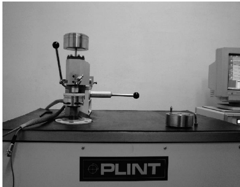
Figura 4. 6: Equipamento de ensaio de resistência ao desgaste do tipo pino-sobre-disco
