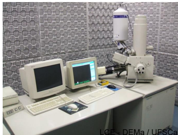
Figura 4. 3: Microscópio Eletrônico de Varredura do Laboratório de Caracterização Estrutural (LCE)
