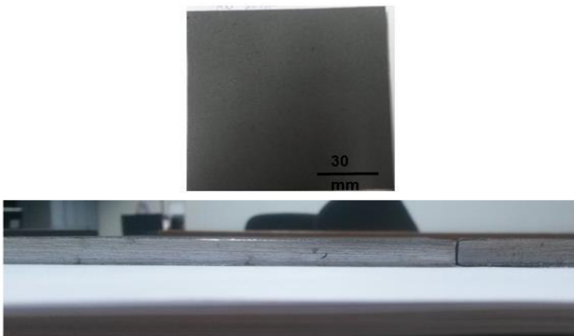
Figura 5. 15: Revestimento obtido com os pós da liga SM-14Cr-0,7B com granulometria inferior a 20 \mu\text{m} .
