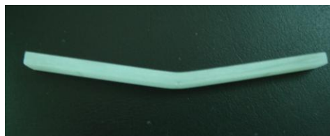
Figura 50: Fotografia de um corpo de prova de flexão da resina epóxi sem fibras após o ensaio.
