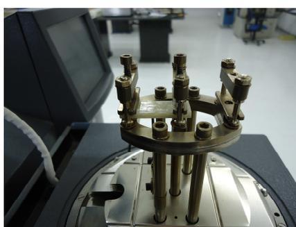
Figura 3.28: Fixação da amostra complementar no dispositivo *single cantilever* do DMA.
