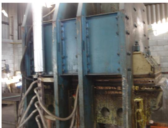
Figura 3.3: Prensagem da chapa do laminado em prensa hidráulica.
