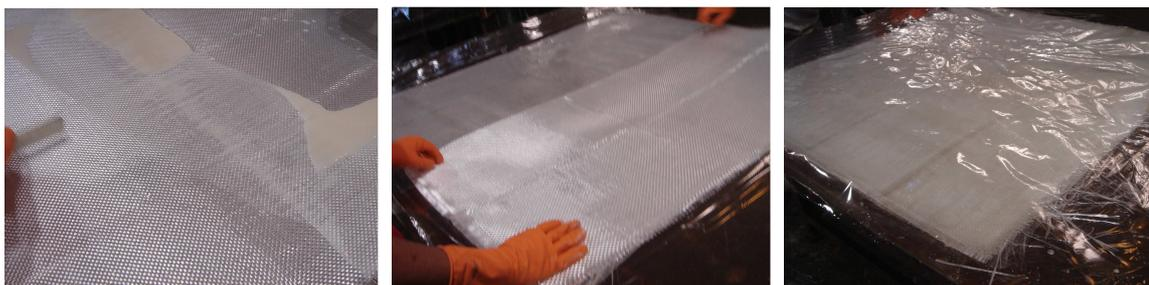
Figura 3.2: Sequência da laminação das camadas por processo de laminação manual. Por final colocação de um filme plástico (BOPP) como desmoldante, para evitar que a chapa ficasse aderida nas placas da prensa.
