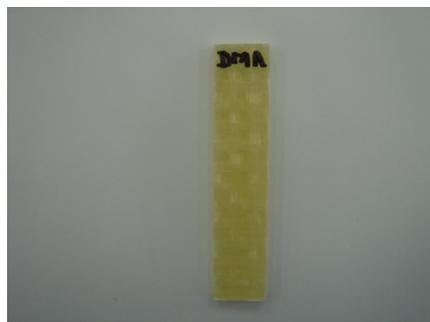
Figura 3.26: Formato do corpo de prova utilizado no ensaio de DMA.
