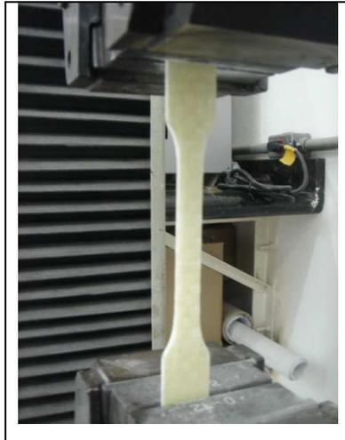
Figura 3.9: Corpo de prova (CDP) fixado na garra para realização da tração.
