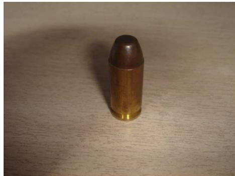
Figura 3.20: Munição calibre 0.40 de polegada fabricante CBC tipo ETPP (Encamisado Total Ponta Plana).
