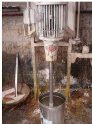
Figura 3.1: Mistura dos componentes com batedor tipo caulins.
