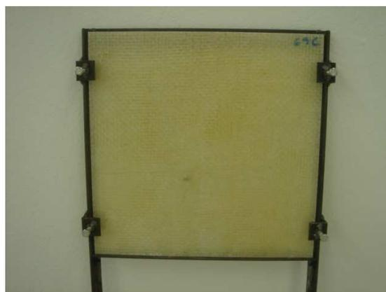
Figura 3.22: Suporte e fixação da amostra de laminado.
