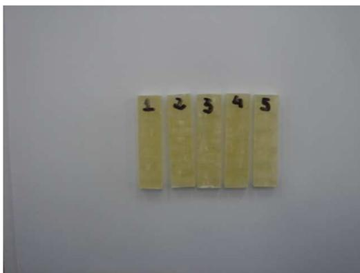
Figura 3.14: Corpos de prova em formato de barras para ensaio de cisalhamento interlaminar.
