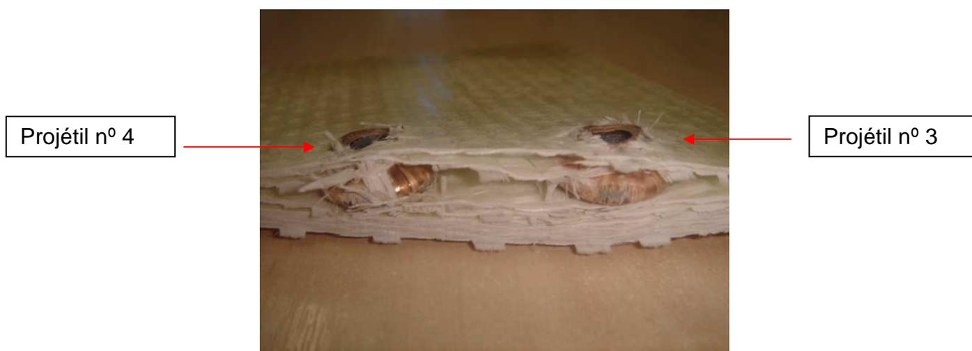
Figura 4.18: Corte transversal na região de impacto dos projéteis de número 3 e 4, onde é possível observar que existem varias camadas intactas.
