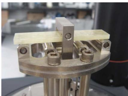
Figura 3.27: Fixação da amostra no dispositivo *3-point bending* do DMA.
