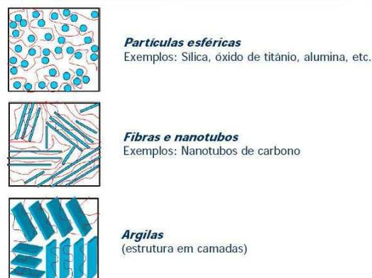
Figura 2.32: Tipos de cargas nano-estruturadas.
