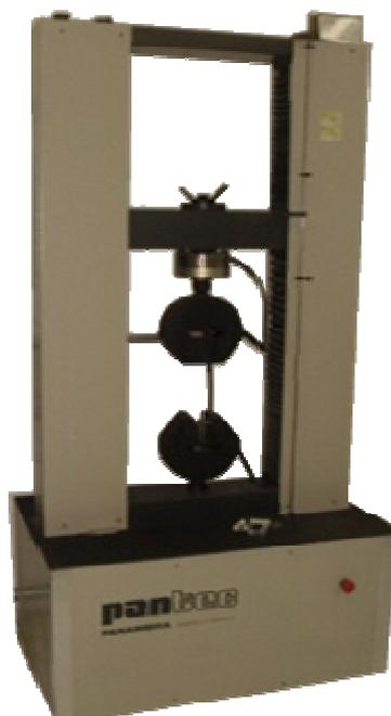
Figura 3.8: Máquina de ensaios universais utilizada.
