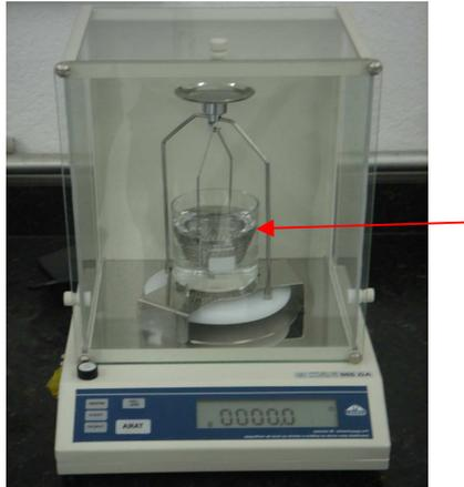
Figura 3.25: Balança analítica com kit para determinação de densidade por imersão (indicado pela seta vermelha).
