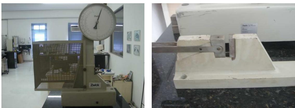
Figura 3.16: Máquina de ensaio de impacto e suporte de fixação do corpo de provas para IZOD.
