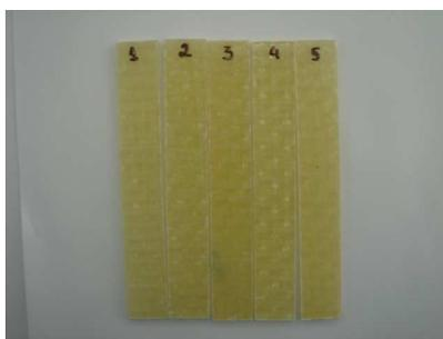
Figura 3.11: Corpos de provas em formato de barras para ensaio de flexão
