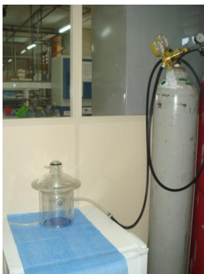
FIGURA 16 - Sistema utilizado, constituído por um dessecador, com entrada e saída para gás, ligado a um cilindro de nitrogênio.
