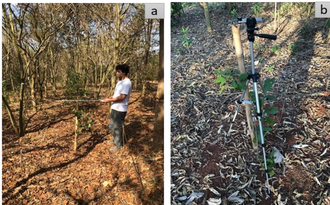
Figura 7 – Coleta de dados na restauração florestal; a) Medição da radiação fotossinteticamente ativa (RFA) com ceptômetro; b) Registro de fotografia hemisférica com celular com clip fisheye acoplado a sua câmera e fixado a um tripé.
