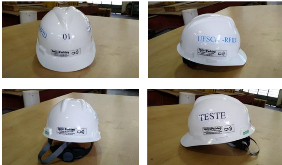
Figura 4.10 – Capacetes equipados com Tags RFID utilizados nos testes
