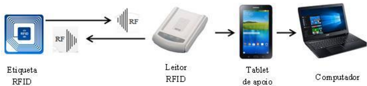
Figura 2.1 – Componentes do sistema RFID
