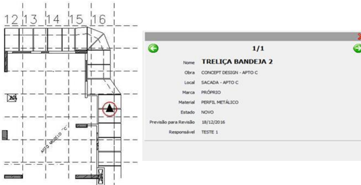
Figura 5.20 – Resultado gráfico da identificação, descrição e localização de um equipamento instalado no canteiro
