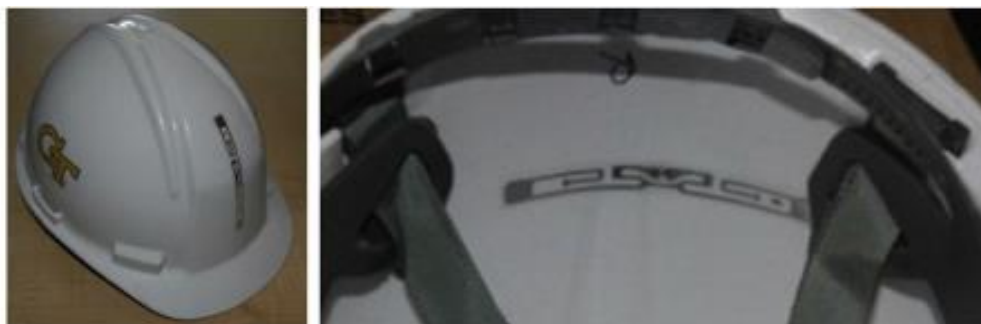
Figura 2.6 – Exemplo de capacete com etiquetas RFID
