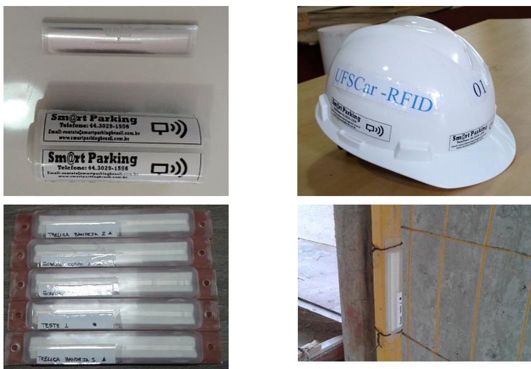
Figura 5.3 – Tags utilizadas para o cadastramento dos equipamentos monitorados
