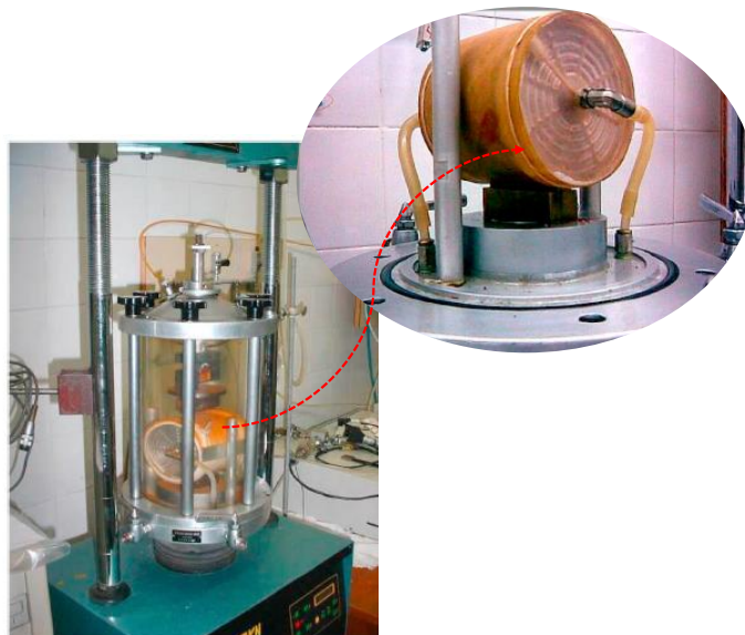
Figura 2.22. Montagem geral do teste na célula triaxial e amostra posicionada sob hastes de metal para o ensaio de compressão diametral (Adaptado de EHRlich e ALMEIDA, 2019).
