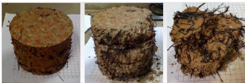
Figura 2.11. Amostras de solo-fibra cortadas para avaliar a orientação das fibras após a compactação (EKINCI e FERREIRA, 2012).
