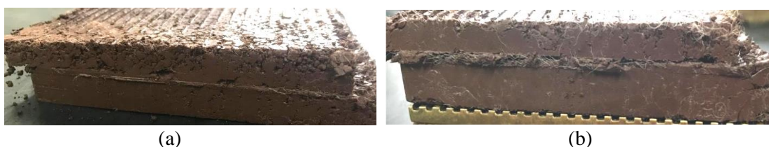
Figura 4.7. Corpos de prova após a ruptura por cisalhamento direto: (a) solo-fibra 0,10%; (b) solo-fibra 0,25%.
