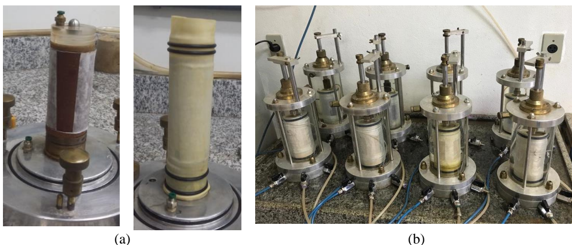
Figura 3.6. Ensaio de compressão triaxial: (a) montagem do corpo-de-prova na célula triaxial; (b) fase de saturação por percolação e por contrapressão.
