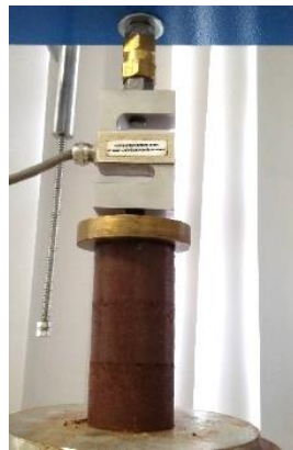
Figura 3.5. Ensaio de Resistência à compressão não confinada.
