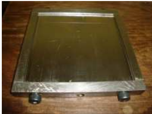
Figura 21. Foto do molde utilizado para preparar as placas de PU e fibra de carbono.
