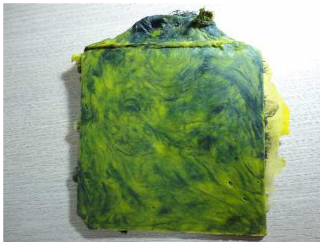
Figura 23. Foto da primeira placa feita de PU e fibra de carbono reciclada (aproximadamente 5 % em massa de fibra de carbono).
