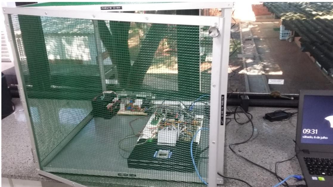
**Figura 7.3: Equipamento de registro dos sinais em MEA, montado no interior da Gaiola de Faraday, desenvolvida pelo autor neste projeto.**
