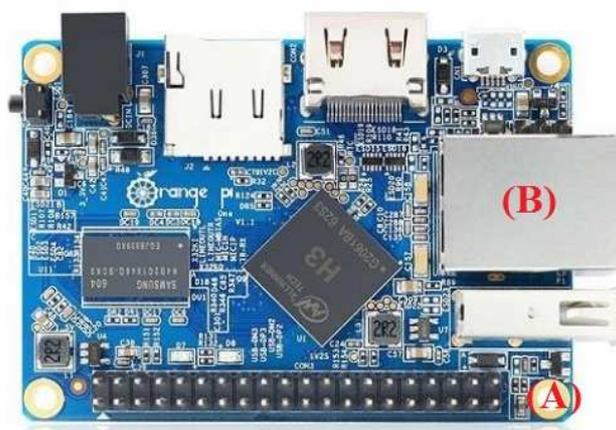
**Figura 3.27: Aspecto da placa *Orange Pi*, mostrando os detalhes do barramento para acesso da interface SPI. Fonte: (ORANGE, 2018).**
