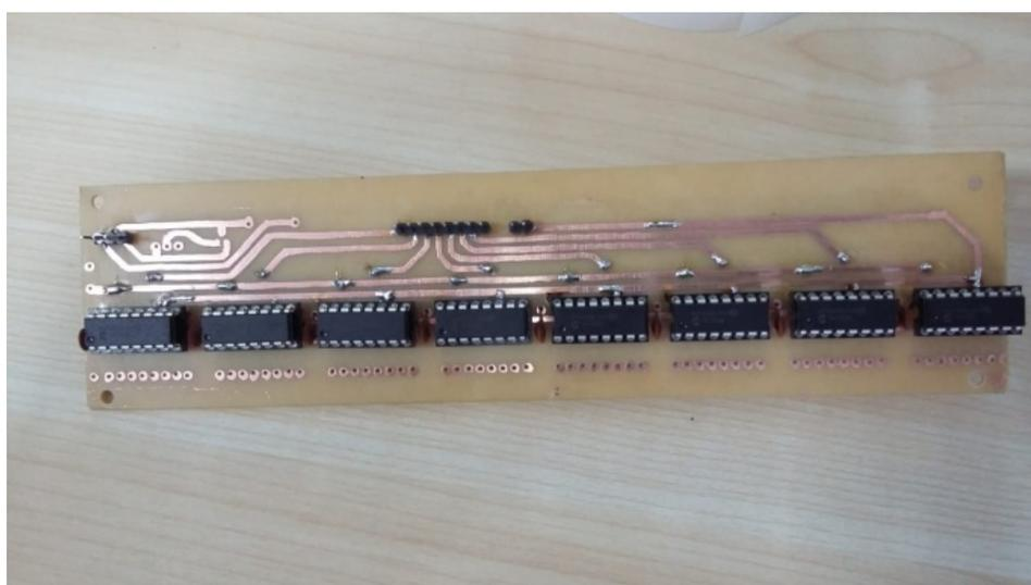
**Figura 3.13: Placa do Conversor Analógico/Digital, com 64 entradas, construídos a partir de 8 circuitos integrados MCP3208. Cada CI apresenta 8 entradas multiplexadas e controlados através de entradas do tipo SPI, conforme descrito no texto.**
